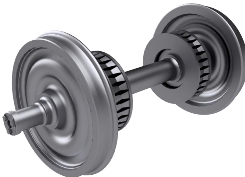
Obr. 8.2 – Modelové dvojkolí s kotoučovou brzdou použité pro určení setrvačných vlastností; Jan Buchta, upraveno
