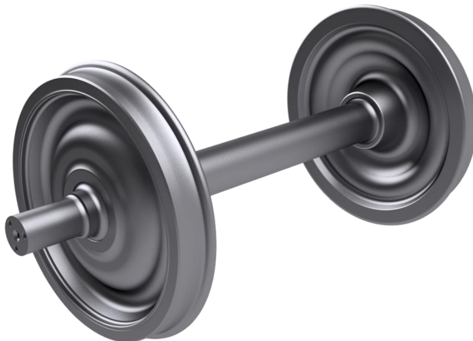
Obr. 8.1 - Modelové dvojkolí bez kotoučové brzdy použité pro určení setrvačných vlastností; autor
