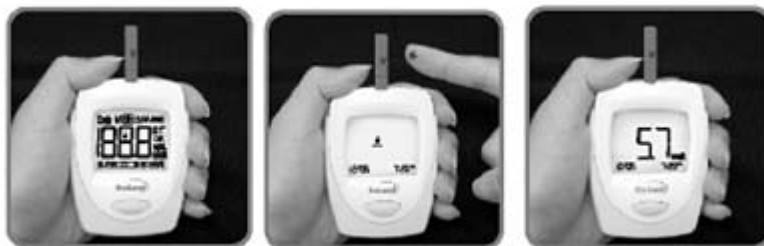
Obr.č.2 Glukometr založený na principu biosenzoru
