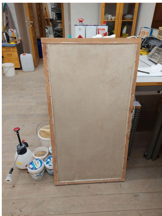
Obr. 04: Průběh přípravy testovacího panelu po nanesení intonaca.
