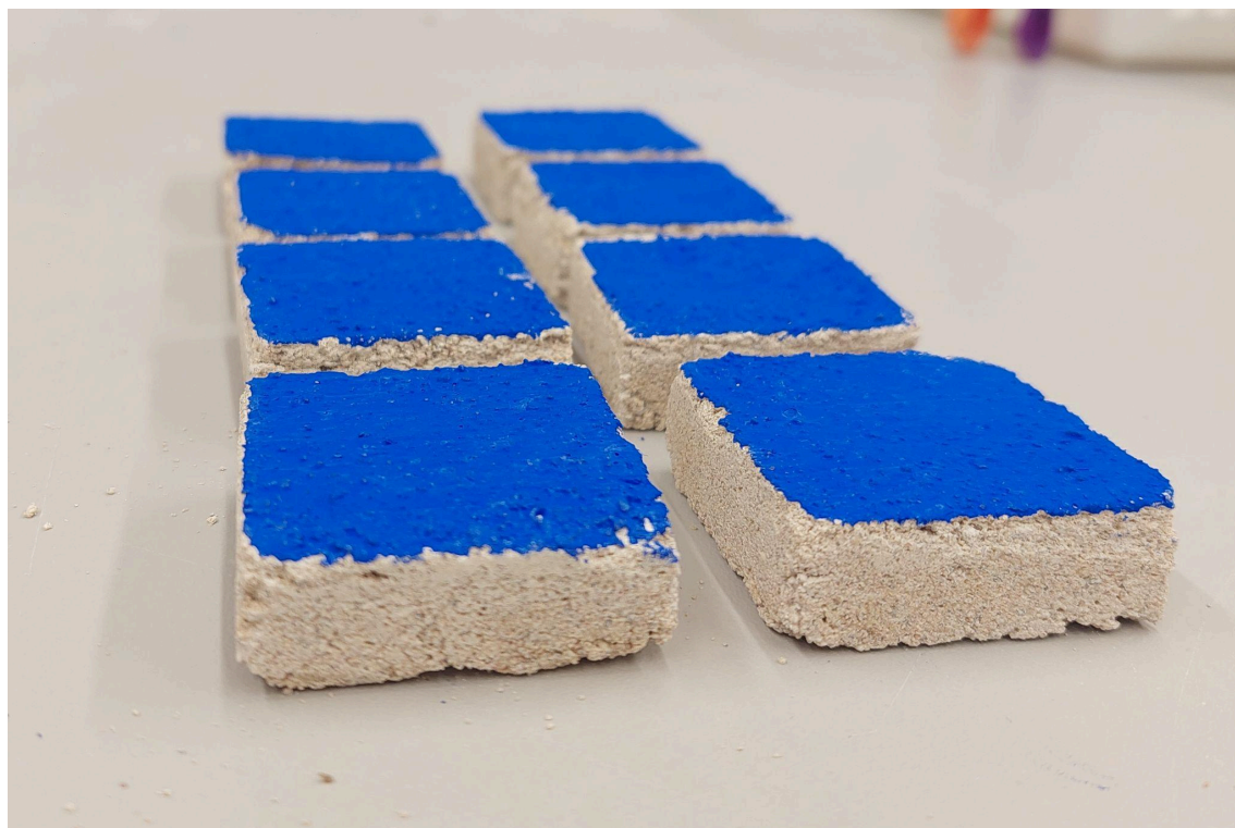
Obr. 06: Testovací tělíska s aplikační plochou 4 cm x 4 cm po nanesení barevné vrstvy.
