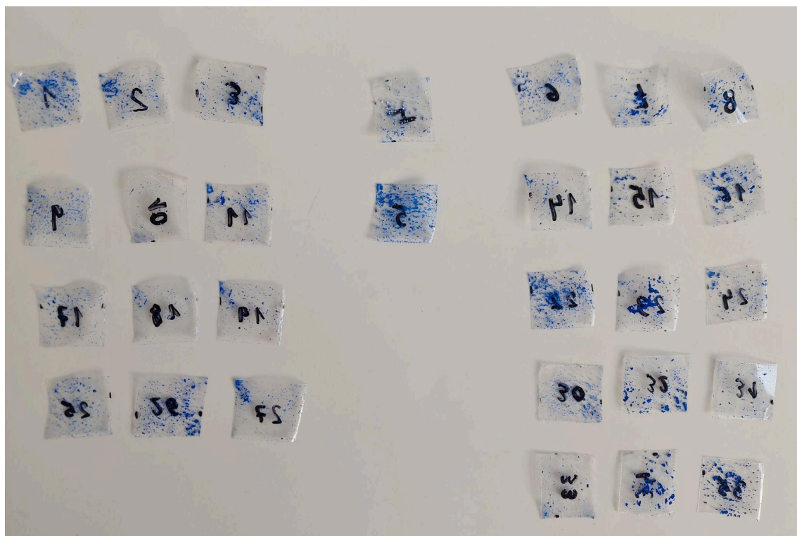
Obr. 16: Scotch-tape test č. 1. In situ metoda. Vzorčky po provedení testu připravené k vážení. Z barevné intenzity lze míru koheze barevné vrstvy vyhodnotit semikvantitativně.
