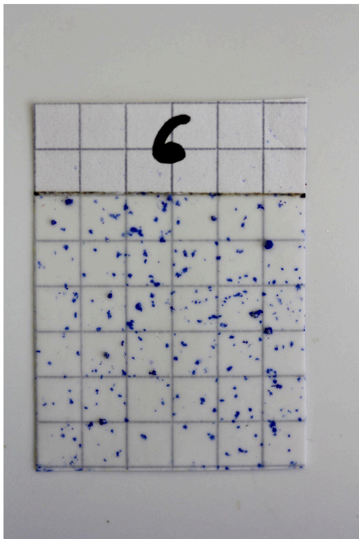
Obr. 17: Scotch-tape test č. 2. Ex situ metoda.
