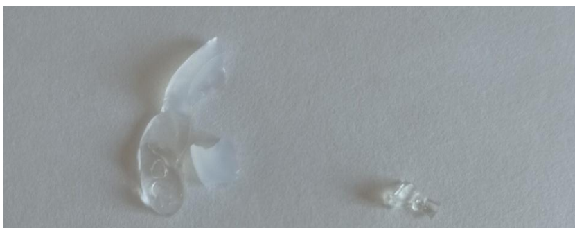
Obrázek 7: Nabobtnaný hydrogel (Vlevo) oproti suchému (Vpravo)
