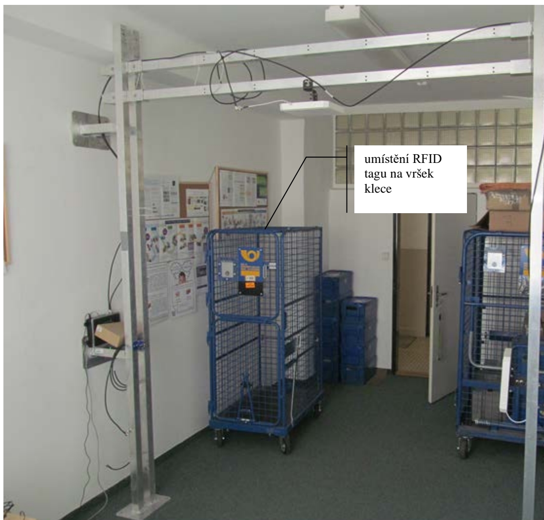
Obr. 18 Umístění RFID tagu na vrch klece [25]
