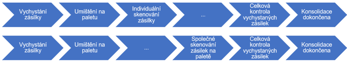
Obr. 26 Dílčí procesy v rámci dvou různých typů experimentálních měření (technologie čárového kódu a QR kódu - horní proces, technologie RFID - dolní proces) [41]
