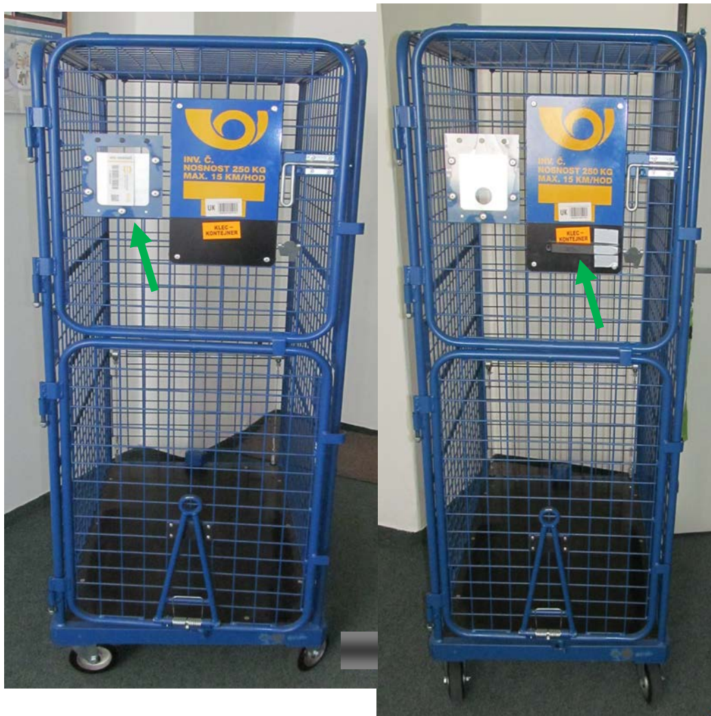
Obr. 17 Umístění RFID tagu na dveřích klece [25]
