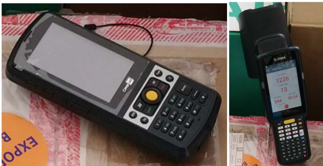
Obr. 24 P Mobilní čtečka (1D a 2D kódů) CIPHERLAB CP30 (vlevo) a mobilní čtečka RFID ZEBRA MC3390R (vpravo) [41]
