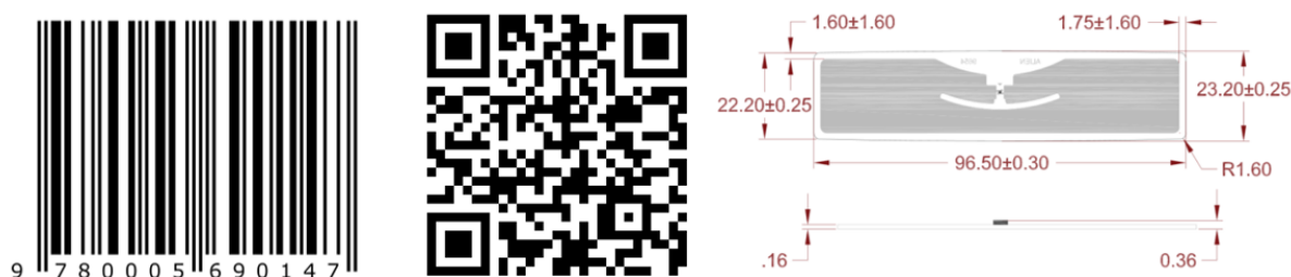
Obr. 20 Použitý kód EAN-13, QR kód a RFID UHF tag ALN-9654 "G" Inlay při experimentálních měřeních [40]
