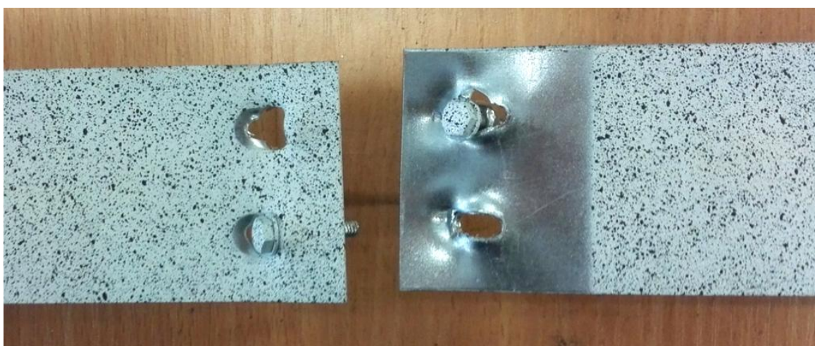
Obr. 35 Šroubovaný zkušební spoj po porušení
