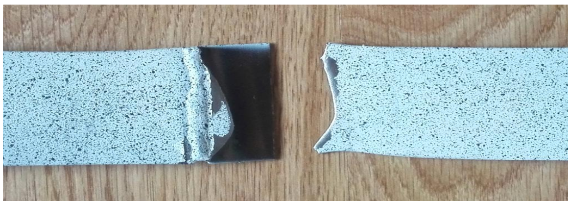
Obr. 28 Svařovaný zkušební spoj po porušení
