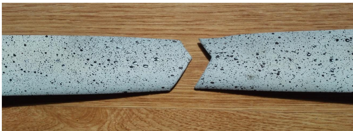
Obr. 26 Referenční vzorek po porušení
