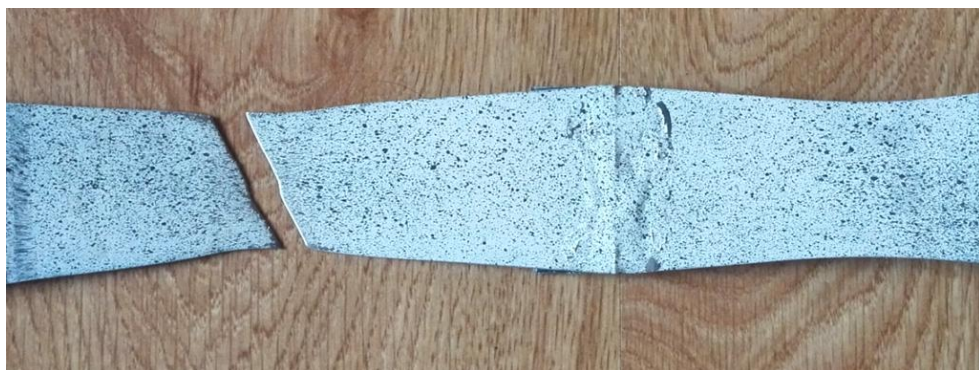
Obr. 30 Pájený Zkušební vzorek po porušení
