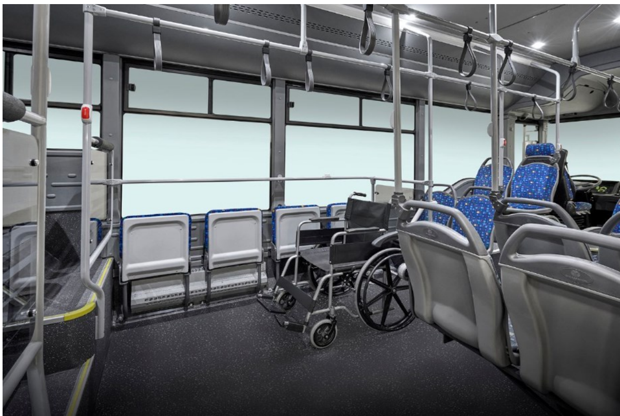
Obrázek 43 Isuzu Novo Citi Life, uzpůsobení interiéru pro vozíčkáře (Turancar Isuzu, 2024)
