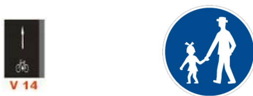
Obrázek 5: Dopravní značka č. V 14 „Jízdní pruh pro cyklisty“, šipka a orientace symbolu jízdního kola. Dopravní značka č. C 7a „Stezka pro chodce“.
