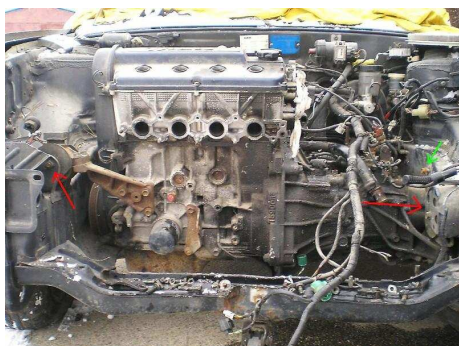
obrázek č. 3 – Demontáž motoru
