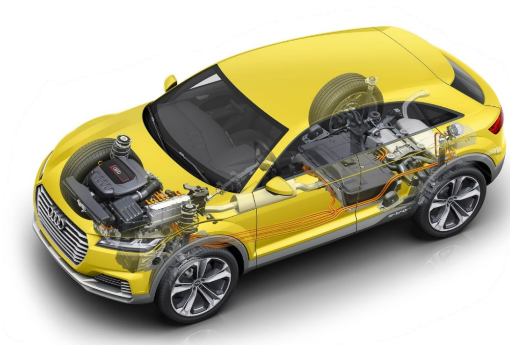
Obrázek 7: Koncepce 4x4 s elektrickým motorem [26]
