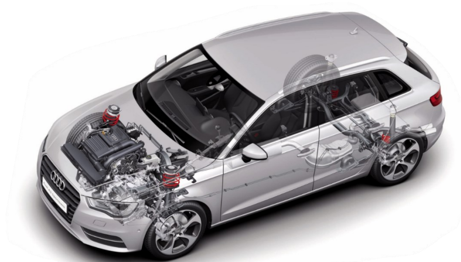
Obrázek 3: Koncepce s předním pohonem a příčně umístěným motorem [22]
