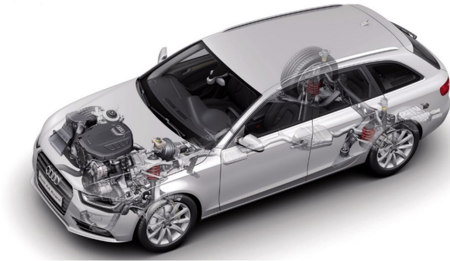
Obrázek 2: Koncepce s předním pohonem a podélně umístěným motorem [21]
