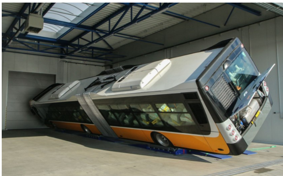
Obrázek 20: Test maximálního náklonu autobusu [27]
