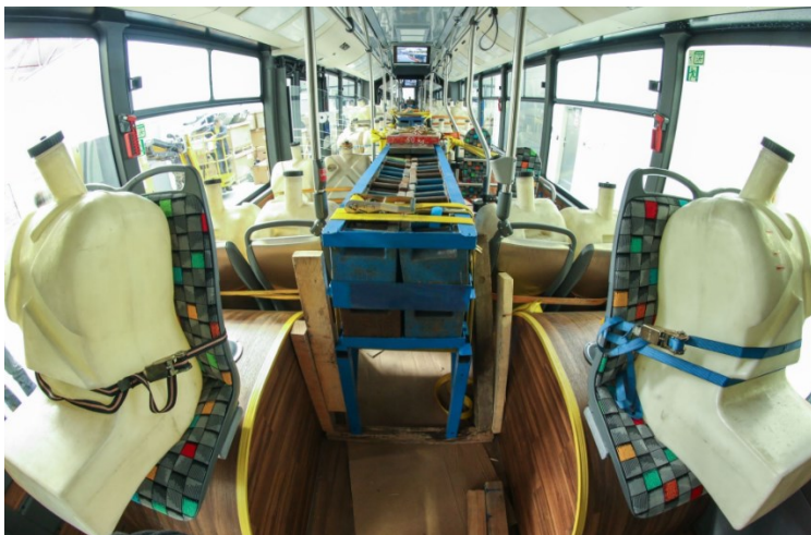
Obrázek 19: Zatížení autobusu při testu náklonu [27]
