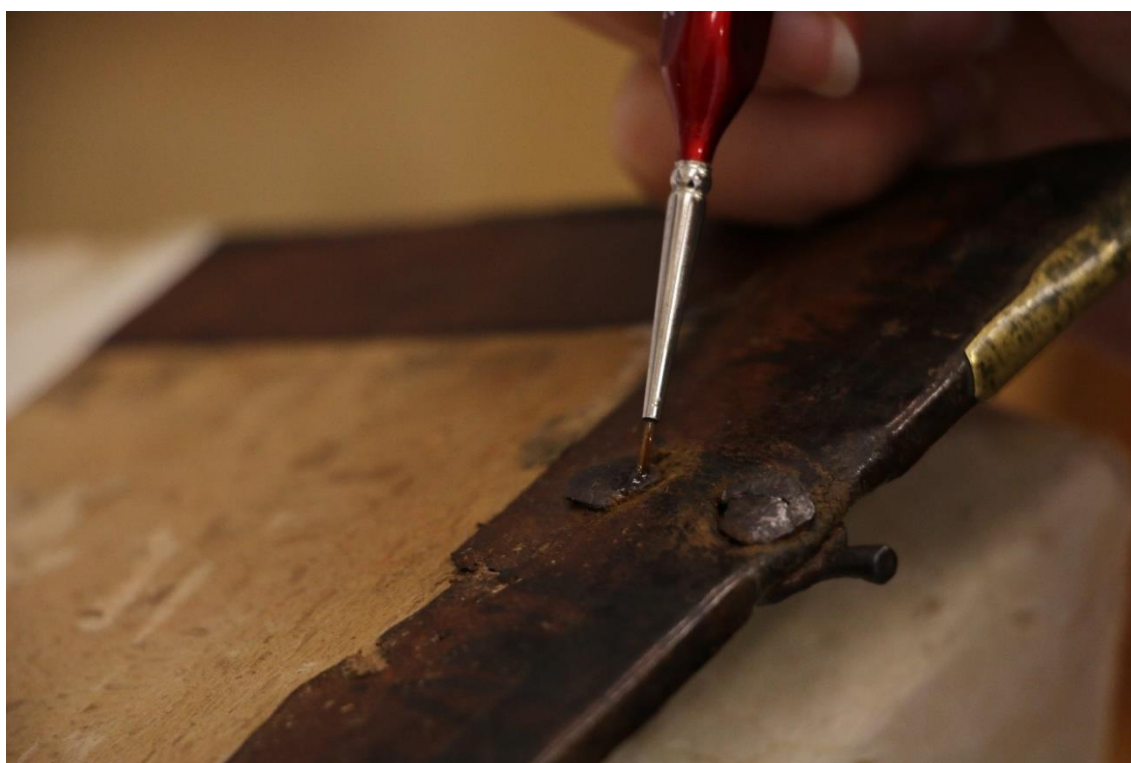
obr. 89 Konzervace ocelového kování nátěrem 5% roztoku Paraloidu B 72 v toluenu
