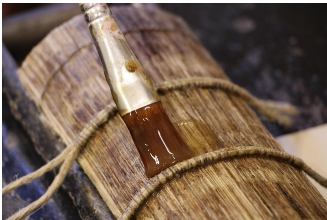
obr. 61 Klížení hřbetu knižního bloku po kulacení
