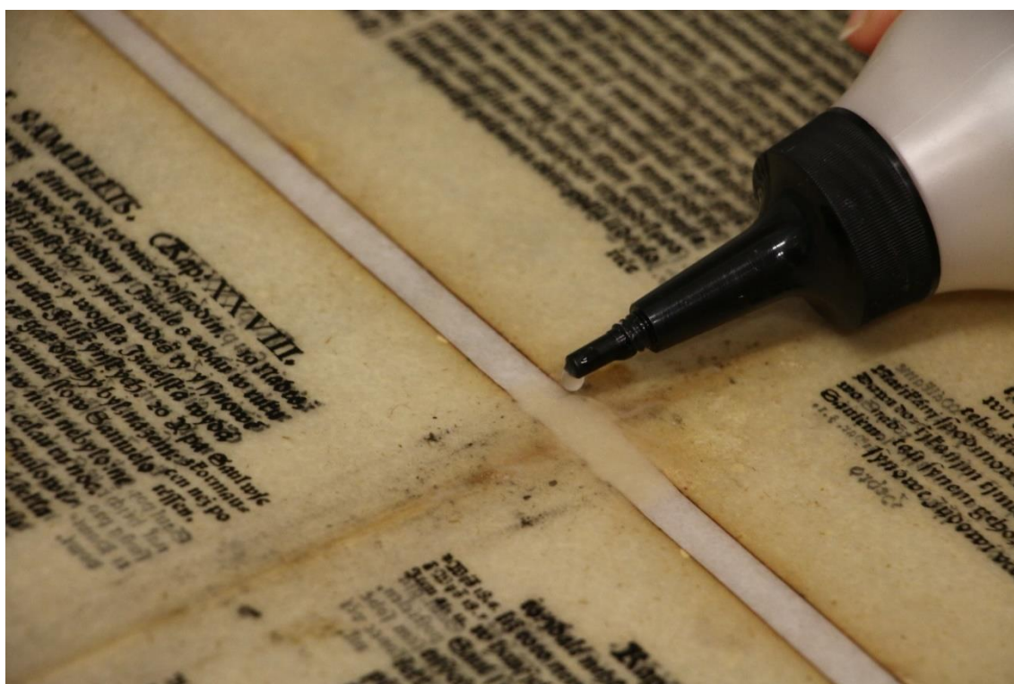
obr. 54 Dolévání ztrát papírové podložky papírovou suspenzí
