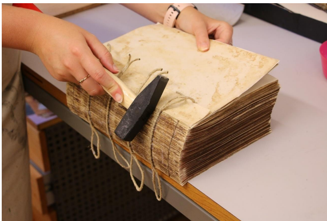
obr. 60 Kulacení hřbetu knižního bloku boční stranou kladiva
