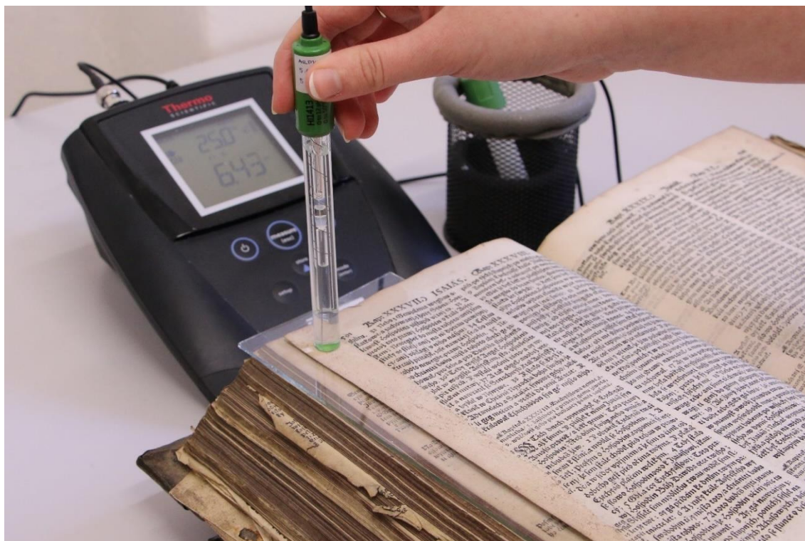
obr. 44 Měření pH papírové podložky
