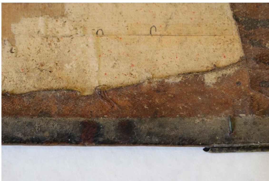
obr. 80 Zkoušky mokrého čištění – vlevo pěna Alvolu, napravo demineralizovaná voda
