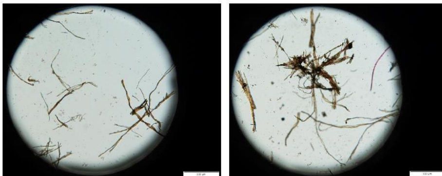
Obr. 3, 4 Vzorek v měřicí cele FP82, před měřením teploty smršštění
