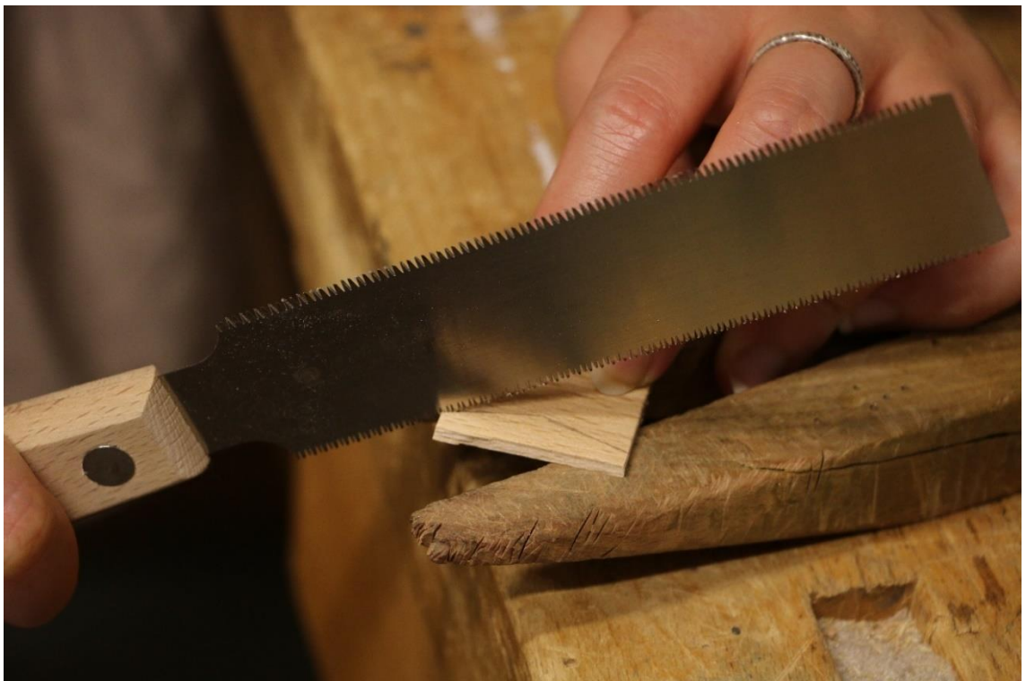
obr. 74 Vyřezání dřevěného motýlka z bukového dřeva
