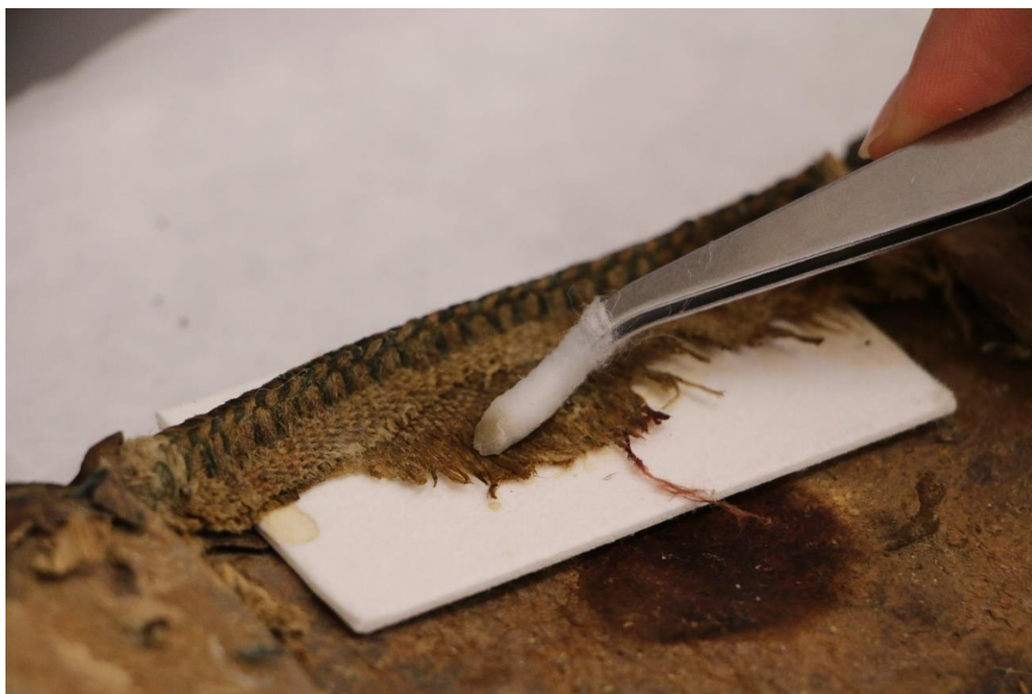
obr. 69 Čištění kapitálku demineralizovanou vodou na filtračním papíru
