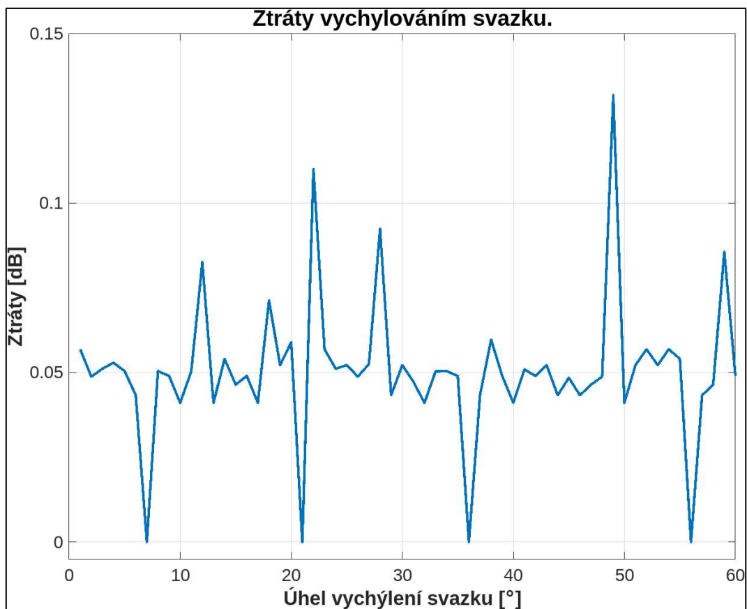
Obr. 3.9 Ztráty vychýlováním svazku – 4bit fázovač
