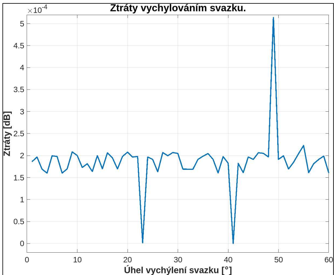
Obr. 3.13 Ztráty vychýlováním svazku – 8bit fázovač
