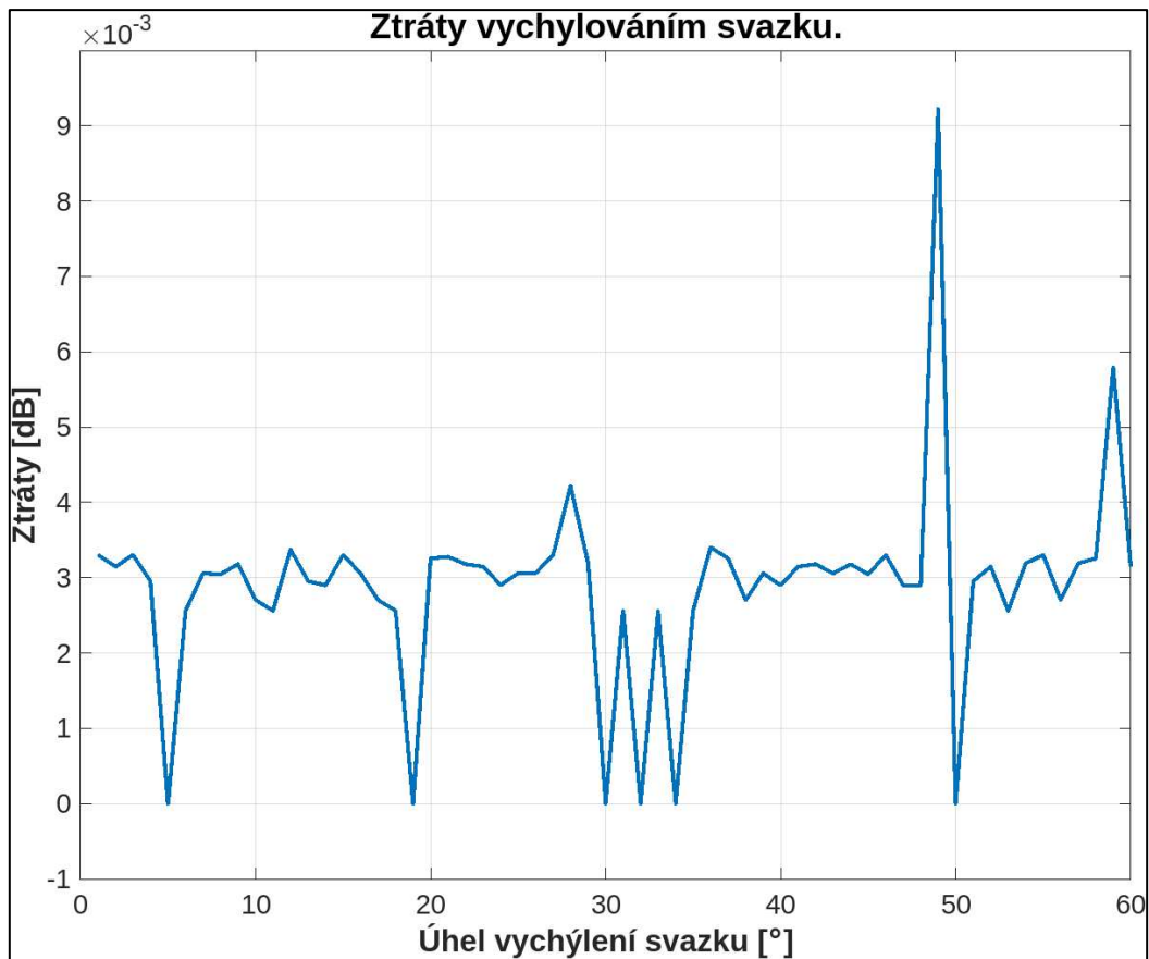
Obr. 3.11 Ztráty vychylováním svazku – 6bit fázovač
