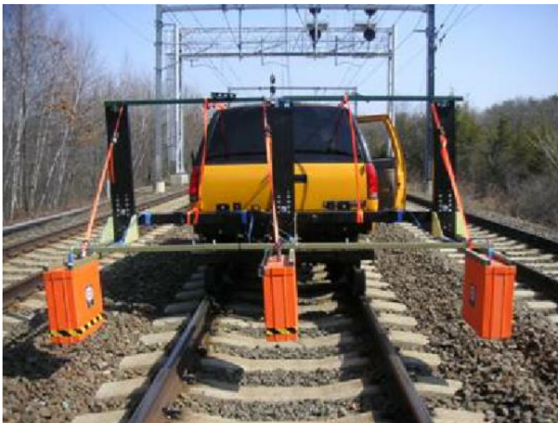
Obrázek 11 - Sestava GPR na dvoucestném vozidle [37]
