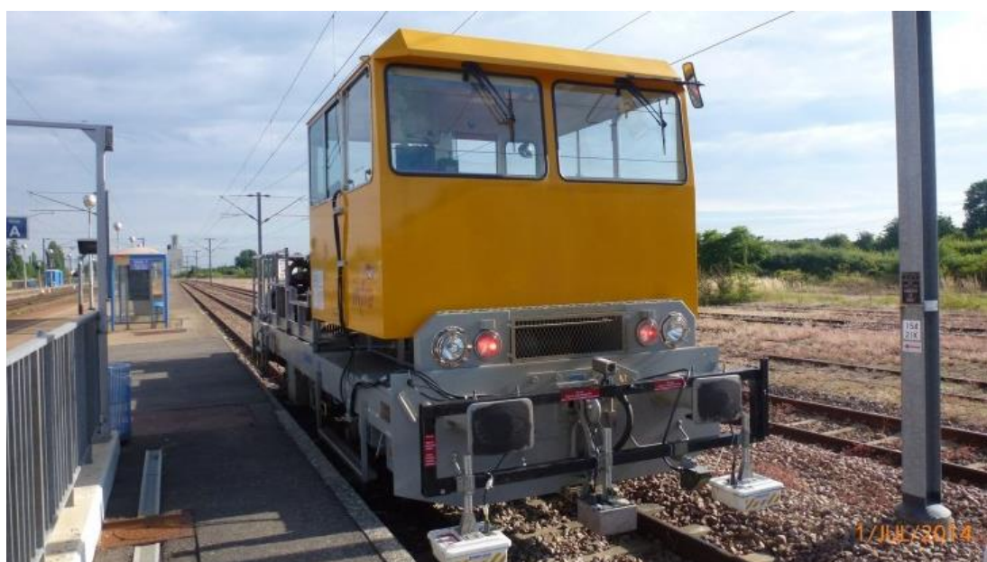
Obrázek 12 - Sestava GPR na kolejovém vozidle [38]
