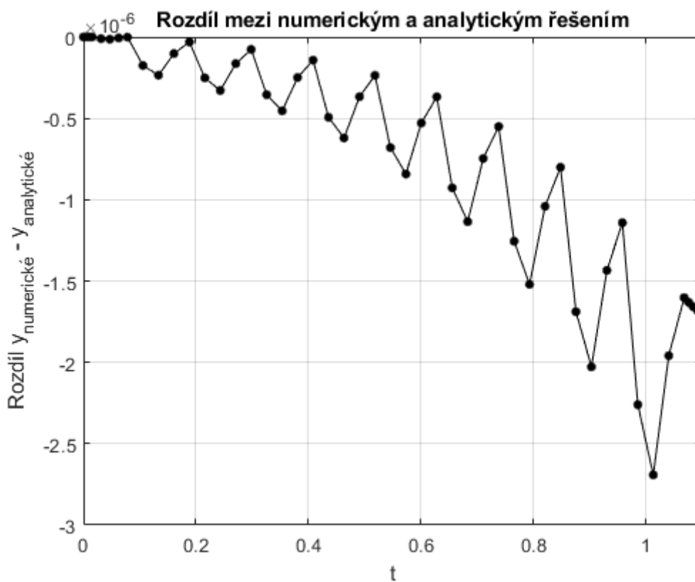
Obrázek 3: Graf rozdílů mezi numerickým a analytickým řešením diferenciální rovnice y'' - 3y' + 2y = 0 (ode45)
