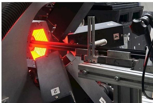
Obr. 27: Extruze EPDM profilu – iniciace sířování (vulkanizace) na výstupu z extruzní hubice [1]
