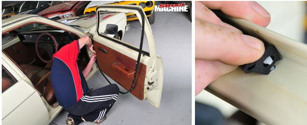
Obr. 20: Montáž vnějšího těsnění dveří pomocí klipů [6]
