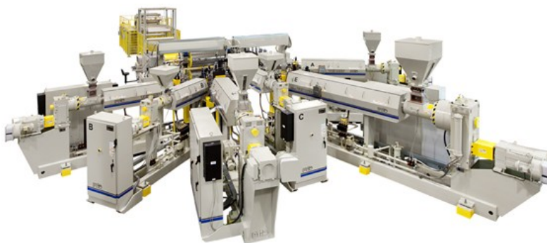
Obr. 28: Vybavení linky pro koextruzi [1]
