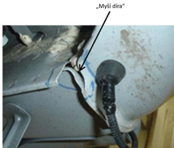
Obr. 3: Příklad vzniku větší mezery mezi plechy karoserie – tzv. „myší díra“. Upraveno [4]
