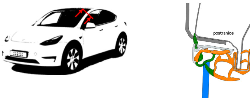
Obr. 9: Příklad koncepce těsnění u bezrámečkových dveří [1]
