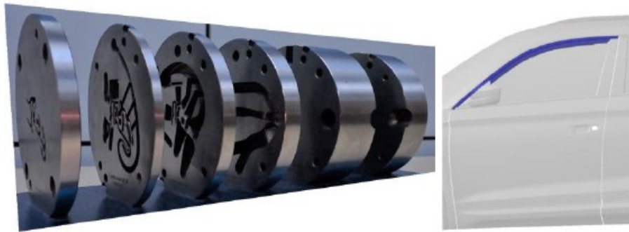
Obr. 26: Příklad extruzní hubice – střešní profil vedení skla [1]
