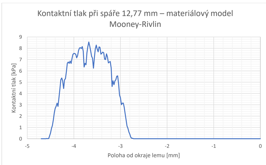
Obr. 67: Průběh kontaktního tlaku – Mooney-Rivlin (homogenní + mikroporézní EPDM), spára 12,77 mm
