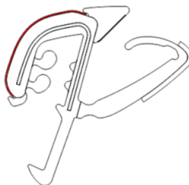
Obr. 13: Vnější stírací těsnění s chromovou termoplastickou folií [1]
