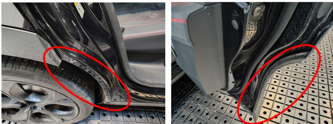
Obr. 50: Postranice karoserie a přilehlá oblast kontaktu těsnění po jízdních zkouškách
