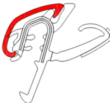
Obr. 11: Montovaná hliníková lišta u vnějšího stíracího těsnění [1]
