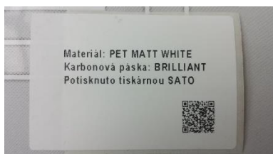
Obrázek 17 Samolepící, polyetylenteretalátová etiketa (Eprin, 2017)
