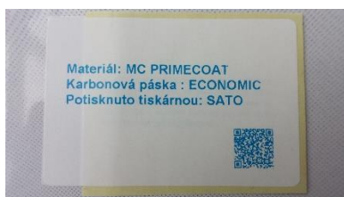
Obrázek 16 Samolepící, papírová, hlazená etiketa (Eprin, 2017)
