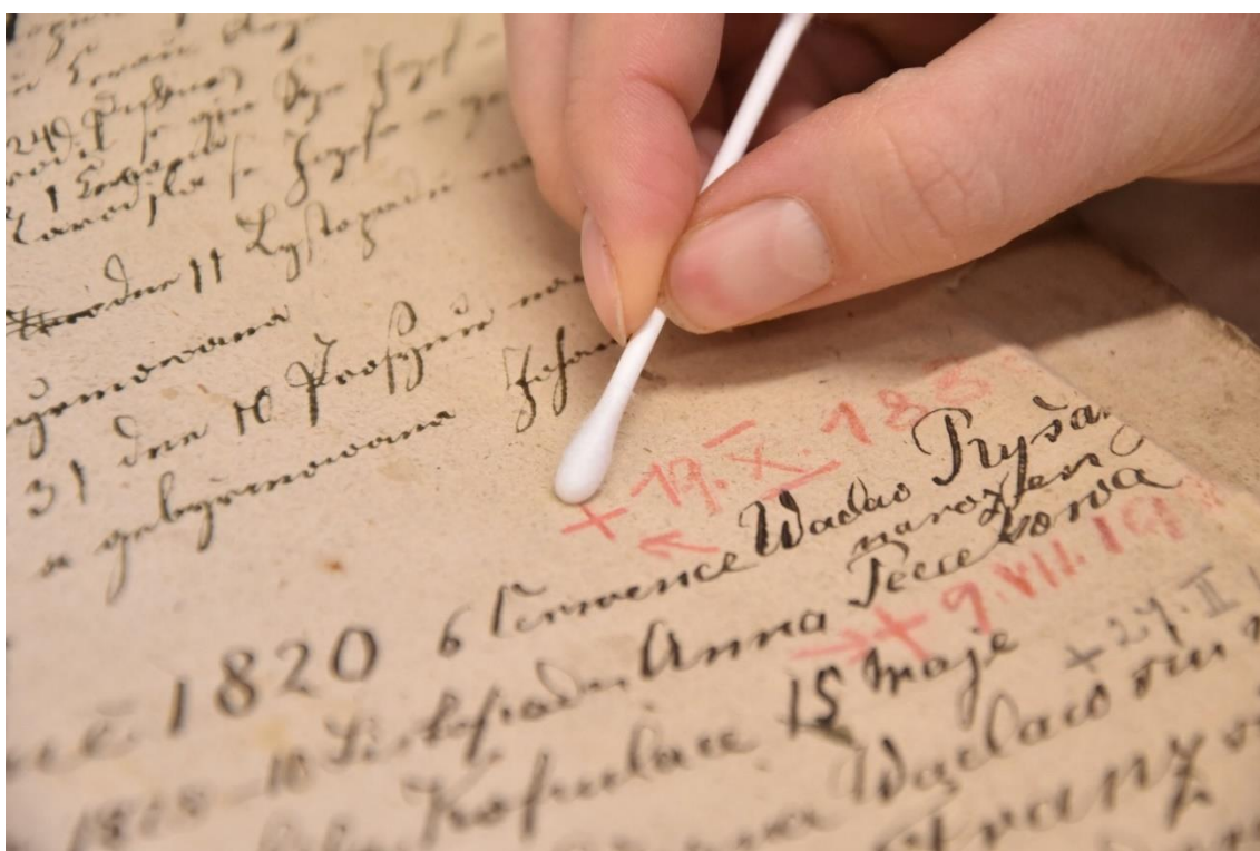
obr. 118 Zkoušky stability záznamových prostředků
