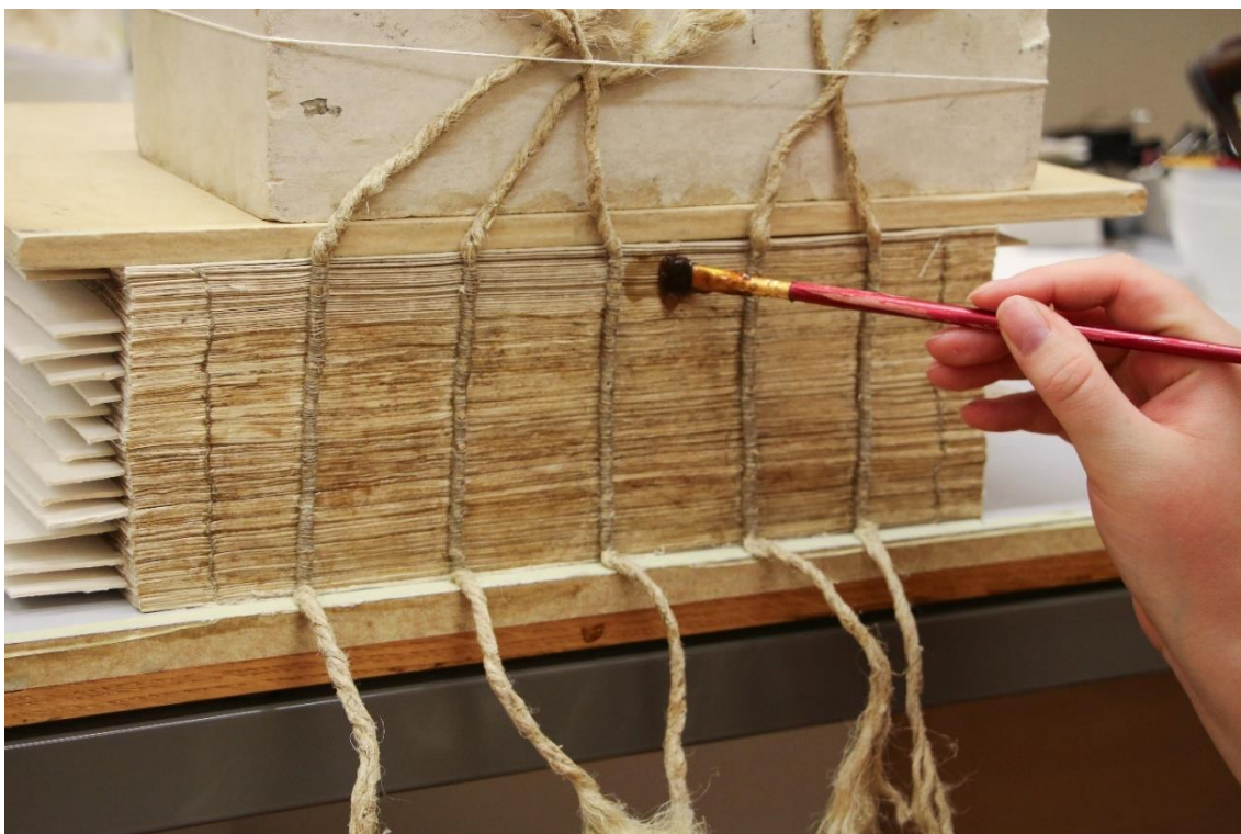
obr. 133 Klížení hřbetu knižního bloku kožním kličem
