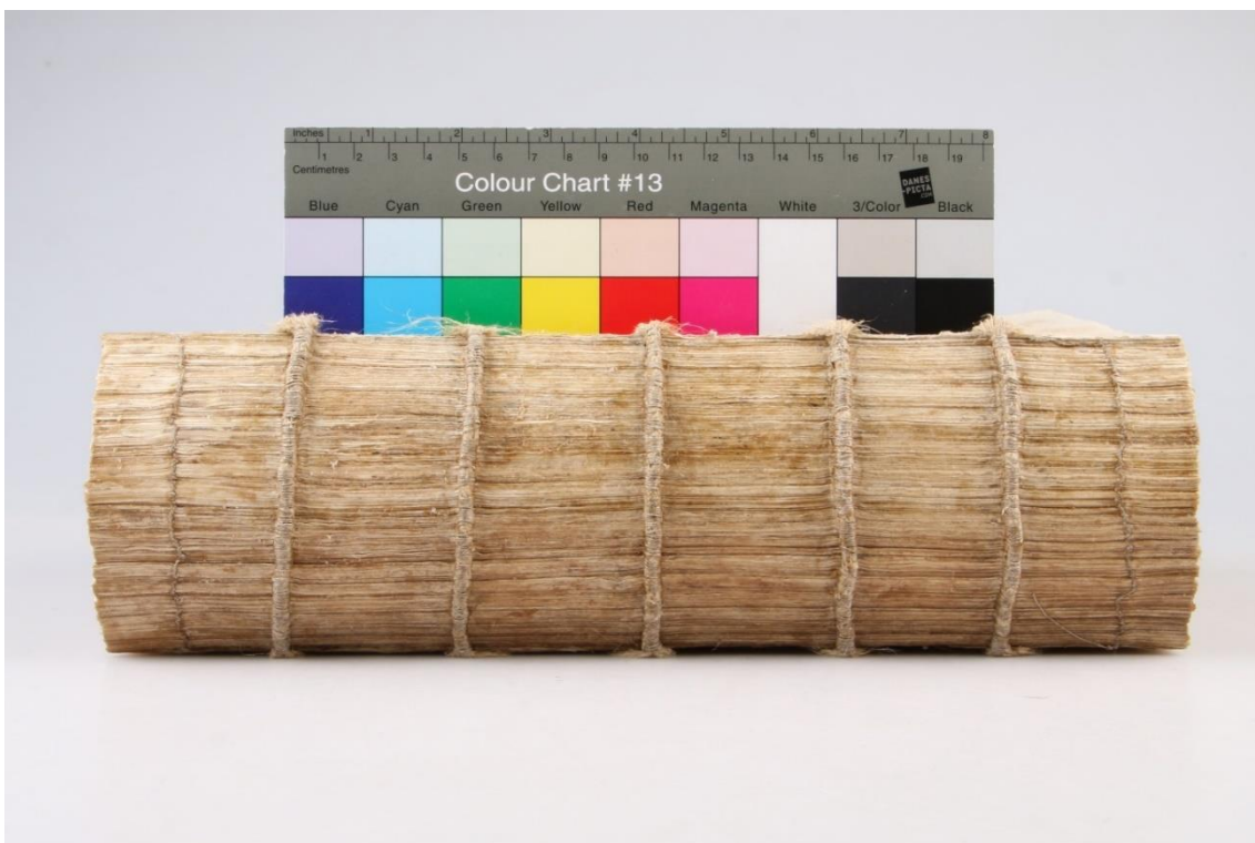
obr. 102 Kolmý pohled na hřbet knižního bloku – stav po zaklizení a zakulacení
