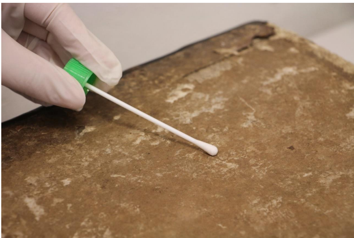
obr. 117 Odběr stěrů pro mikrobiologické analýzy
