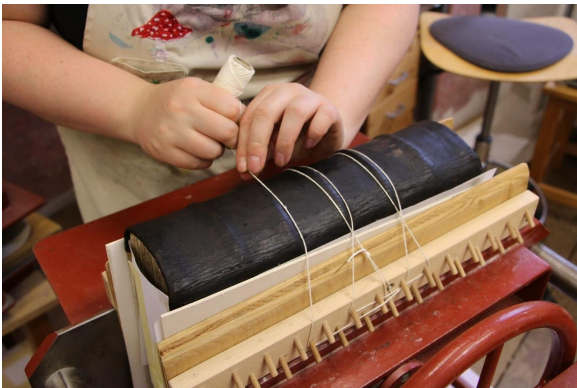
obr. 151 Vyzazování vazů v oklepávacím lise
