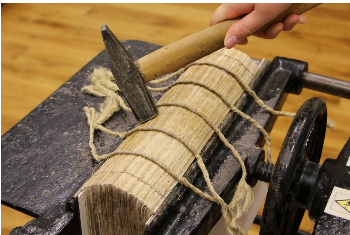
obr. 134 Kulacení hřbetu knižního bloku v oklepávacím lise
