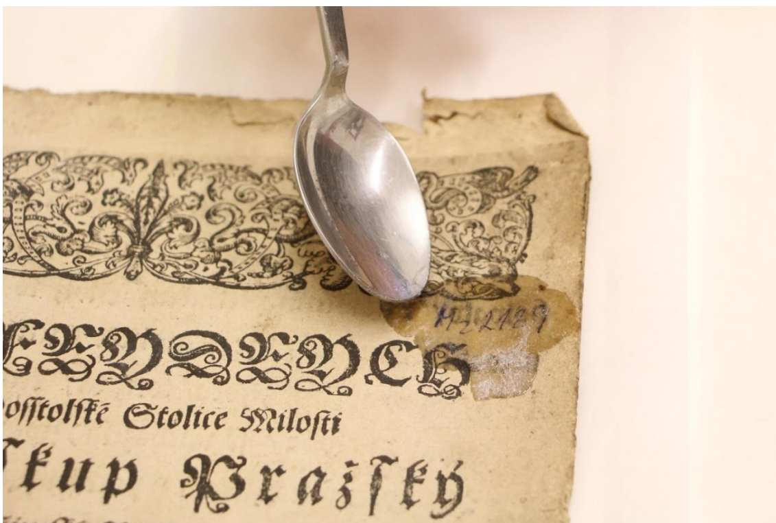
obr. 122 Fixace záznamových prostředků citlivých na vodu taveninou cyklododekanu
