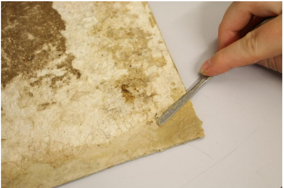
obr. 142 Tmelení lepenkových desek tmelem z papíroviny a 4% Tylose MH6000
