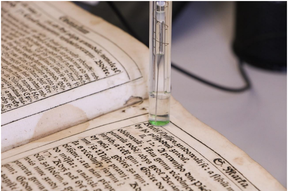
obr. 119 Měření pH papírové podložky před restaurováním
