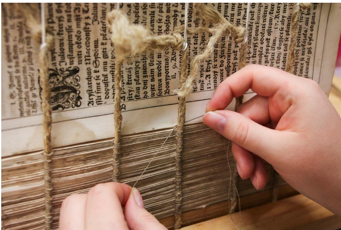
obr. 132 Šití knižního bloku na nové motouzové vazy
