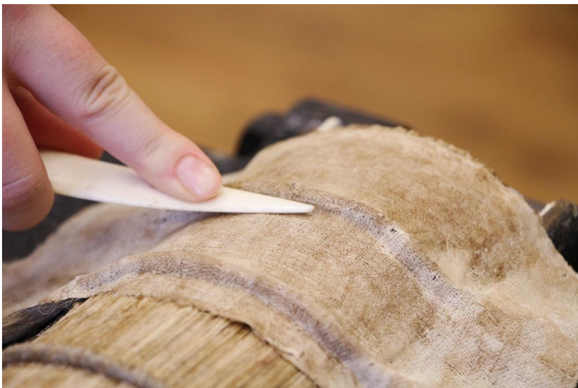
obr. 137 Vylepování plátěných přelepů na hřbet knihy
