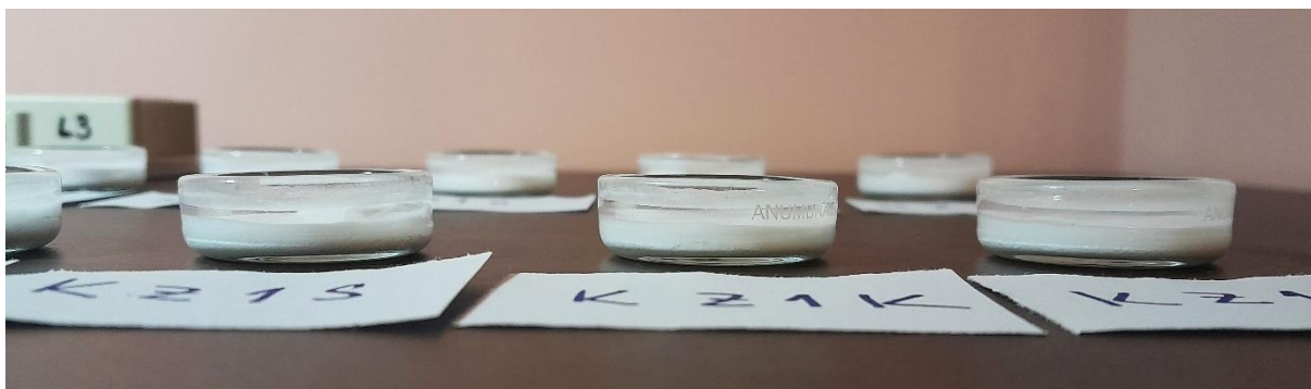
Obr. 9: Sedimentace vzorků vápenné kaše K mražené 1 cyklem v uzavřené nádobě. Viditelná úplná sedimentace vápenného materiálu, přičemž na povrchu zůstala oddělená voda. K sedimentaci došlo přibližně po 10 minutách od vložení materiálu do misky.
