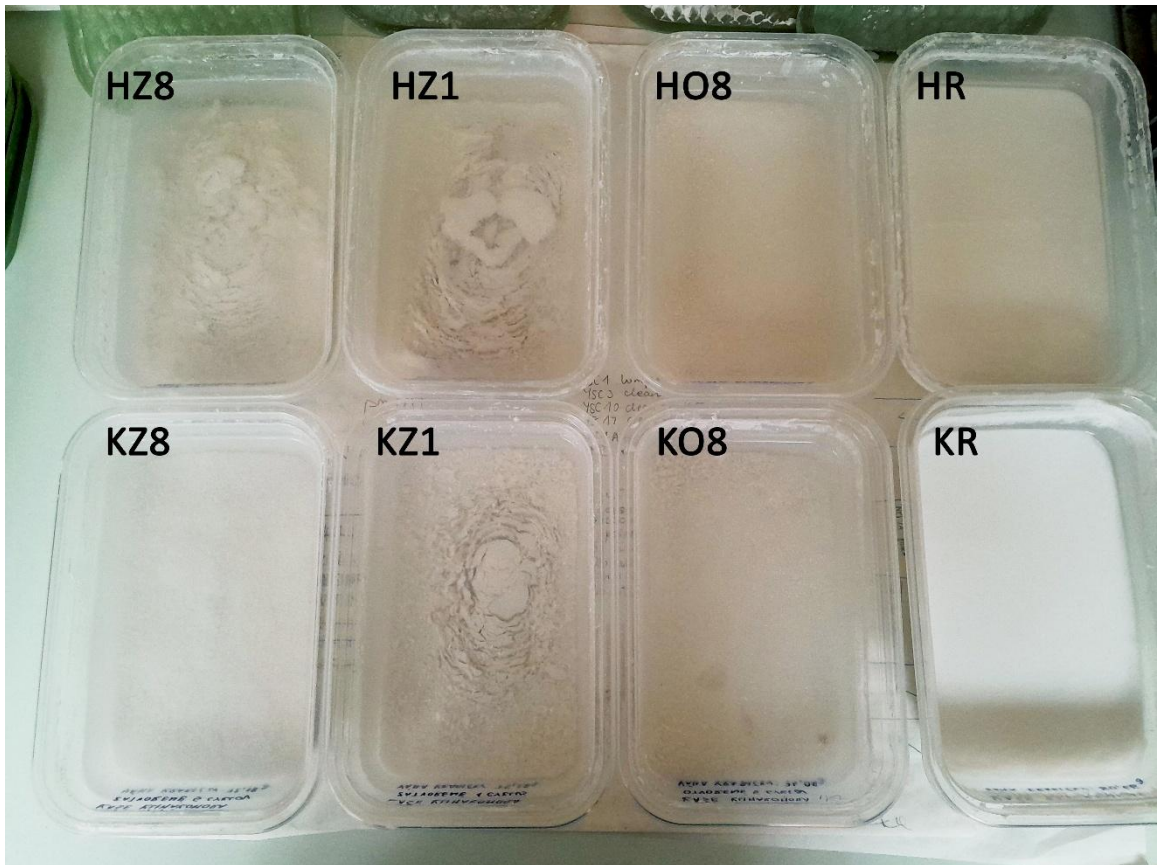
Obr. 7: Vzorky 8 dní po ukončení cyklů v klimatické komoře. Na vzorcích HZ8, HZ1 a KZ1 jsou viditelné krátery uprostřed nádoby, a to z důvodu úniku vzduchu ze dna nádoby po rozmrznutí.
