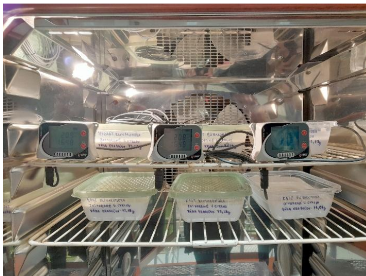
Obr. 2: Vzorky H a K v klimatické komoře před procesem mrazení. Sondy měřiče dataloggeru byly vloženy do nádob se vzorky s vápenným hydrátem.
