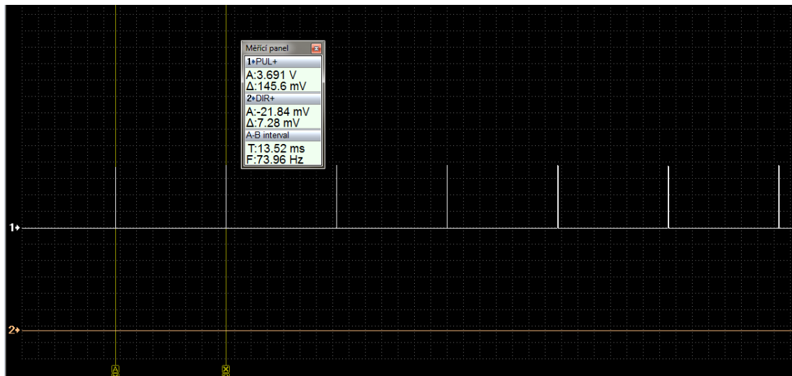
Obrázek 8 Průběh impulsů na svorce PUL+ (CH1) a průběh na svorce DIR+ (CH2)
