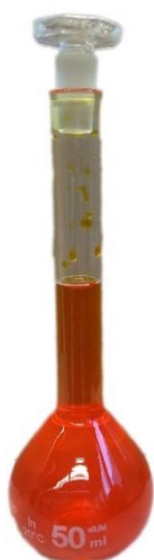
Obrázek 23: Oxidace ethanolu dichromanem draselným v kyselém prostředí
