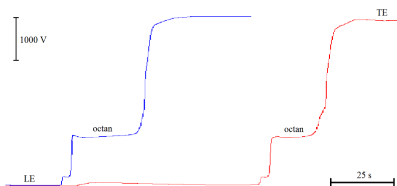
Obrázek 28: Izotachoforeogramy vzorku zelené – bez standardního přídavku (červená), se standardním přídavkem (modrá). Elektrolytový systém: LE: vedoucí elektrolyt 0,01 M histidin-chlorid + histidin (pH 6,2), TE: koncový elektrolyt 0,01 M MES, analytická kolona.
