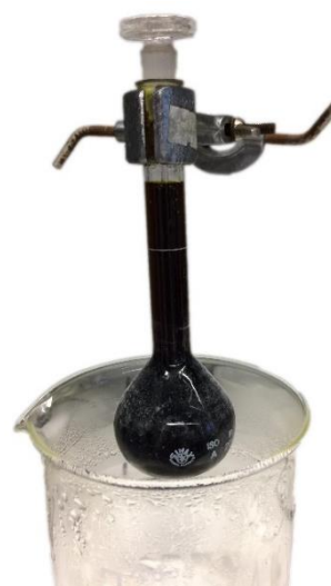
Obrázek 22: Oxidace ethanolu dichromanem draselným v kyselém prostředí ve vroucí vodní lázni
