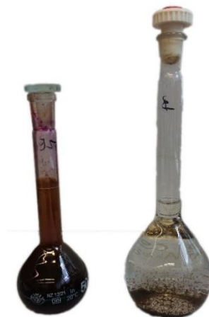
Obrázek 24: Oxidace ethanolu manganistanem draselným v alkalickém prostředí
