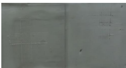
Obrázek 44: Stanovení přilnavosti pojiva s obsahem plniva Steopac A na skleněném panelu exponovaného ve vodě z poloviny plochy (vpravo)
