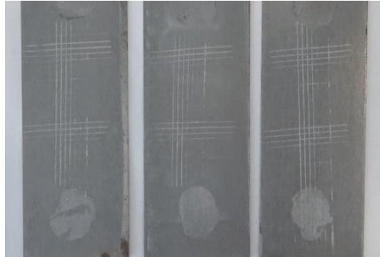
Obrázek 40: Pojivo s obsahem Steopacu A o OKP = 20 %, hodnocení přilnavosti v mřížce
