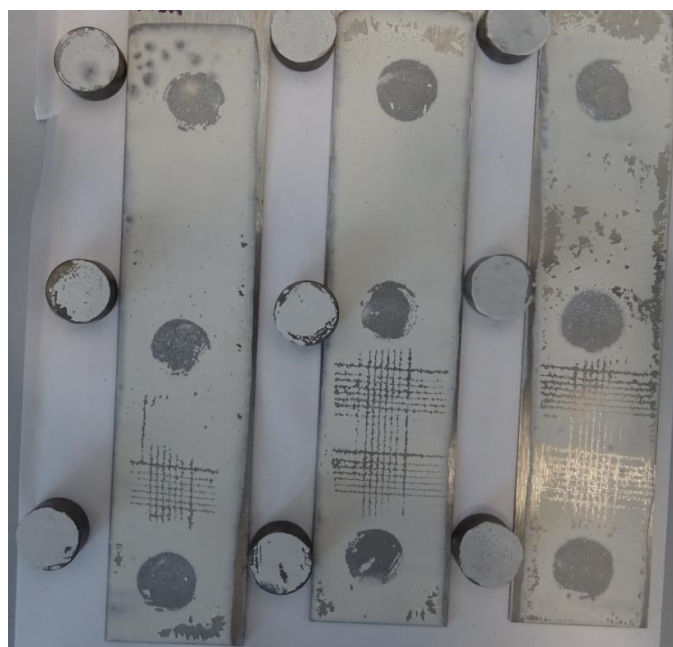
Obrázek 38: Panely s organickým povlakem obsahující ZnO při OKP = 10 % s Omyarbem, , kde adhezní lom mezi podkladem a nátěrovým filmem nastal v ploše odpovídající 25 % a kohezní lom nátěrového filmu (B) nastal v 50 % plochy. Ve zbytku plochy zde došlo ke koheznímu lomu v lepidle.
