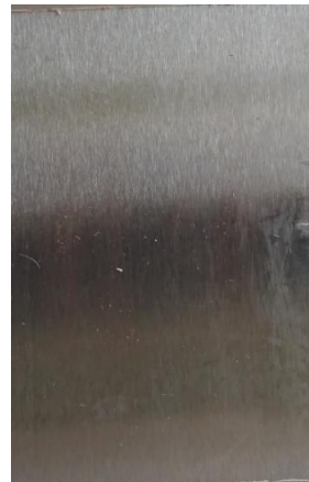
po odstranění nátěru
