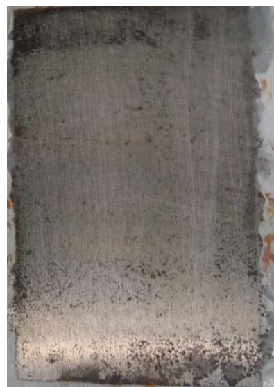
po odstranění nátěru
