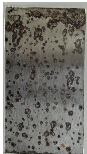
po odstranění nátěru
