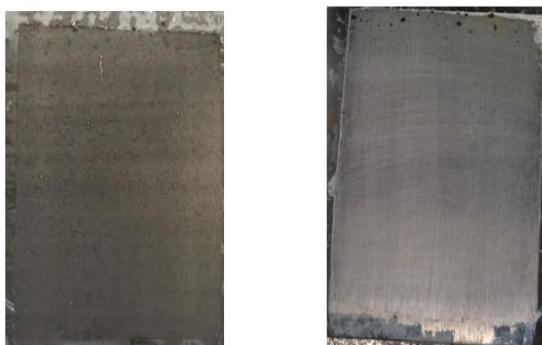
Obrázek 35: Pigmentovaný organický povlak (OKP = 10 %) s obsahem plniva Omyacarb a pigmentu PANI po 120 hodinách korozní zkoušky v SO 2 komoře, panel po odstranění tohoto nátěrového filmu
