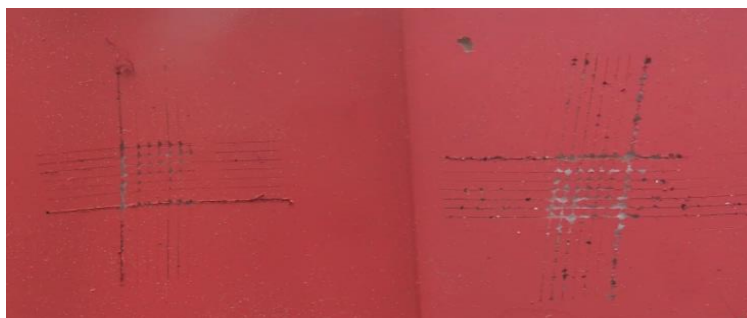
Obrázek 48: Pojivo s obsahem antikorozičního pigmentu Zinkfosfát při OKP = 10 % a plniva Hematit
