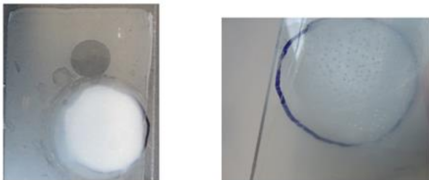
Obrázek 22: Charakterizované vodou ředitelné disperzní pojivo po kontaktu s vodou, detail zbělání a vzniku puchýřků, den 16
