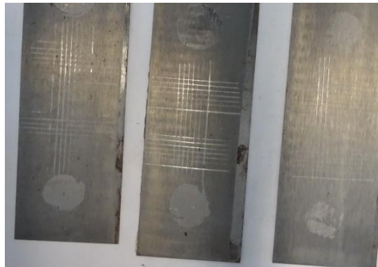
Obrázek 41: Pojivo s obsahem Wollastonitu o OKP = 20 %, hodnocení přilnavosti v mřížce
