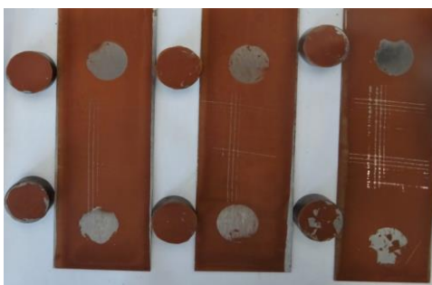
Obrázek 43: Rozdíl v přilnavosti mezi pojivem s pigmentem Zinkferrit s plnivem Omyacarb při použití vybraného promotoru adheze (vpravo) a v případě, kdy aditivum nebylo přidáno (nalevo a uprostřed)
