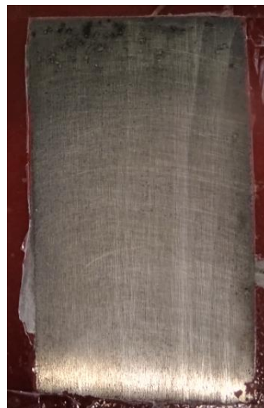
po odstranění nátěru
