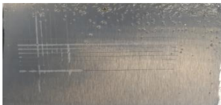
Obrázek 51: Stanovení přilnavosti pojiva bez pigmentu 96 hodin po jeho aplikaci na ocelovém panelu
