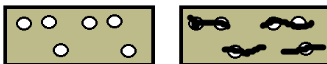
Obrázek 16 Zákryt pórů ve struktuře epoxidu sulfidem molybdeničitým
