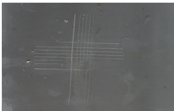
Obrázek 45: Vzhled mřížky pojiva obsahující plnivo Steopac A o OKP = 20 % zhotovené po provedení korozní zkoušky v prostředí neutrální mlhy NaCl
