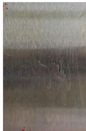
po odstranění nátěru
