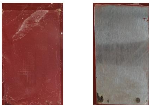
Obrázek 33: Organický povlak s obsahem Mastku (OKP = 20 %) po 120 hodinách korozní zkoušky v solné komoře, panel po odstranění tohoto nátěrového filmu
