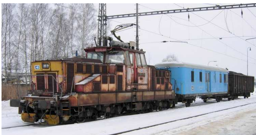
Obr. 6 Lokomotiva 210.046, upravená pro napájení z akumulátorů, umístěných ve služebním voze za lokomotivou [17]
