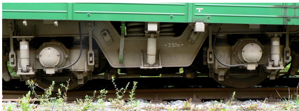
Obr. 12 Pohled na podvozek lokomotivy 114.501 [19]
