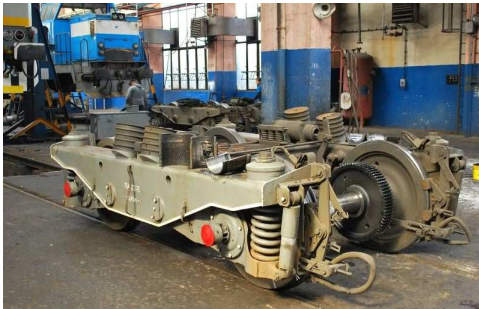
Obr. 25 Podvozek dieselové lokomotivy ČKD 754.072 bez trakčního motoru [18]
