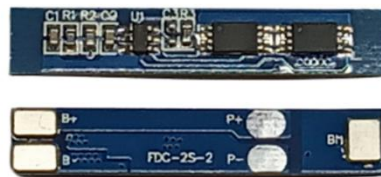
Obr. 3.2 – Modul 3S3A pro ochranu Li-Ion baterií
