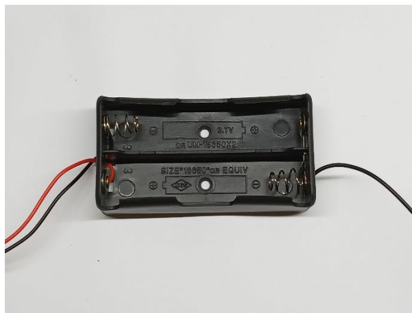
Obr. 3.3 – Box pro uložení dvojice akumulátorů 18650 v sérii
