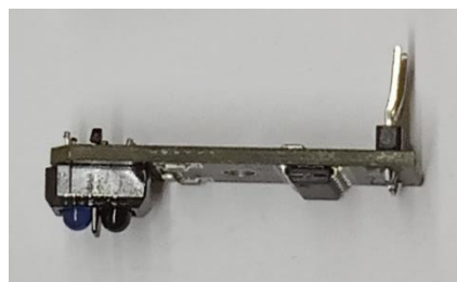
Obr. 3.3 – Modul IR senzoru po úpravě
