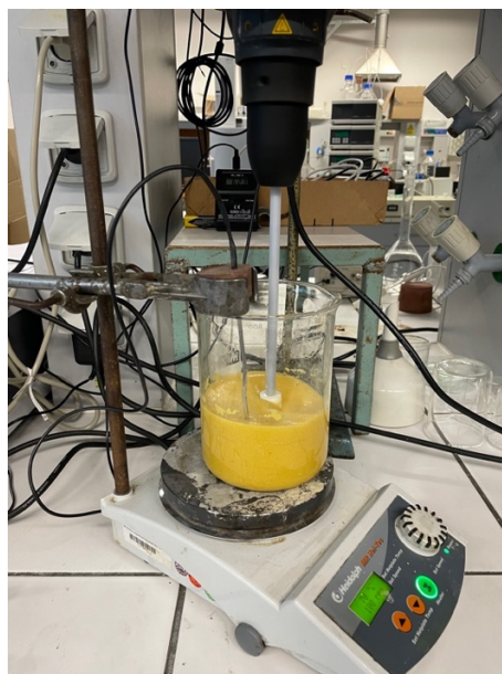
Obrázek 7: Aparatura pro zmýdelnění
