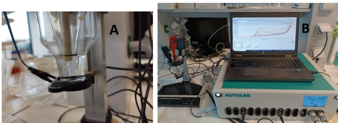
Obrázek 11 Použitě 3 elektrodové uspořádání (A), potenciostat Autolab PGSTAT302N se zapojeným elektrochemickým článkem ve voltametrické nádobce (B).
