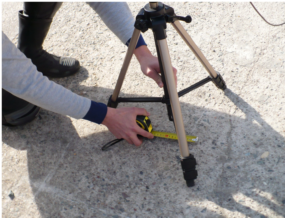
Obr.1 Umístění mikrofonu dle požadavků směrnice ES č. 97/24
