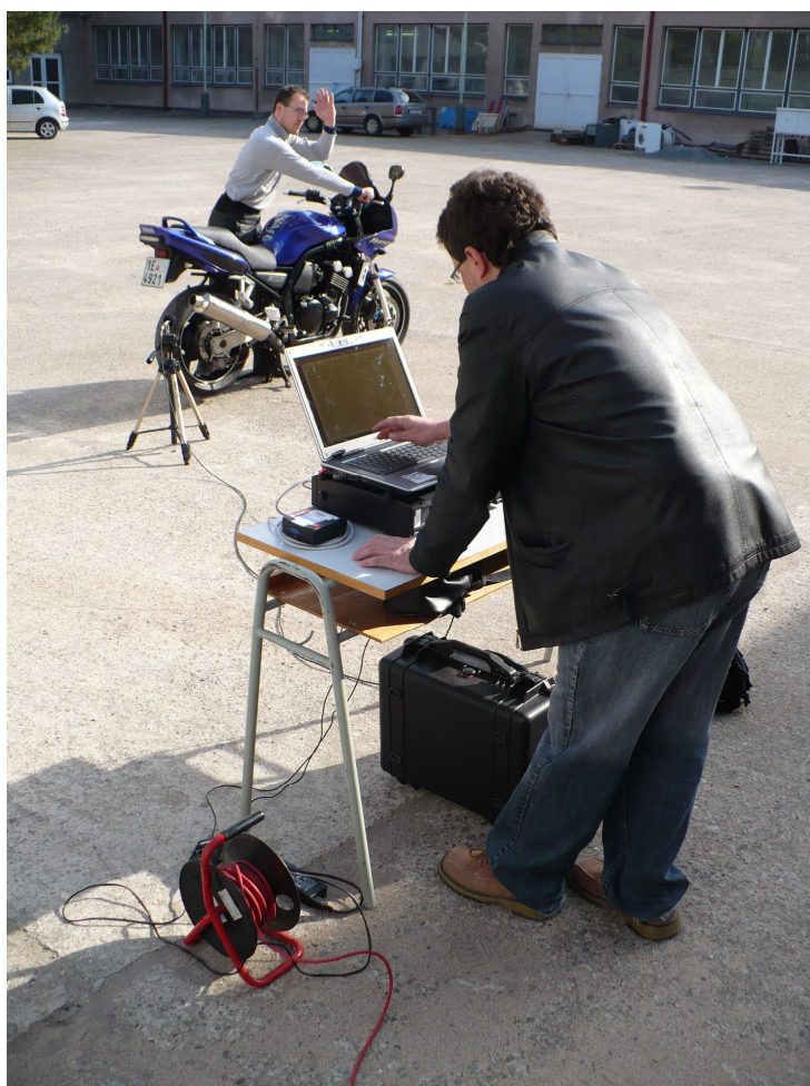
Obr. 4 Smluvený signál – mávnutí ruky – signalizoval ustálení otáček na požadované hodnotě
