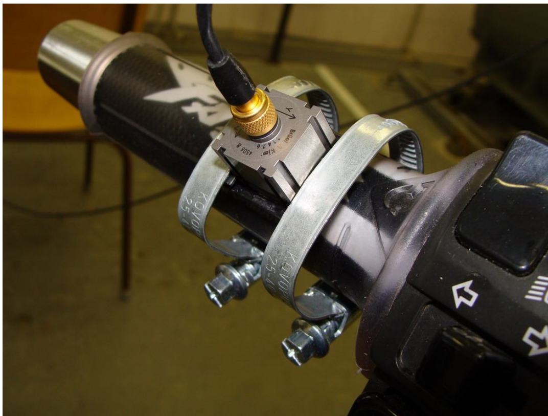
Obr. 2 Uchycení snímače na řídítka motocyklu pomocí hadicových objímek
