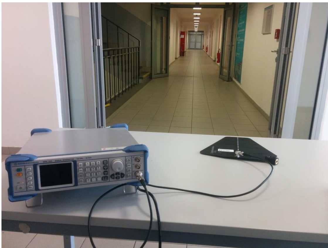
Obrázek 10 - Měření šíření signálu chodbou
