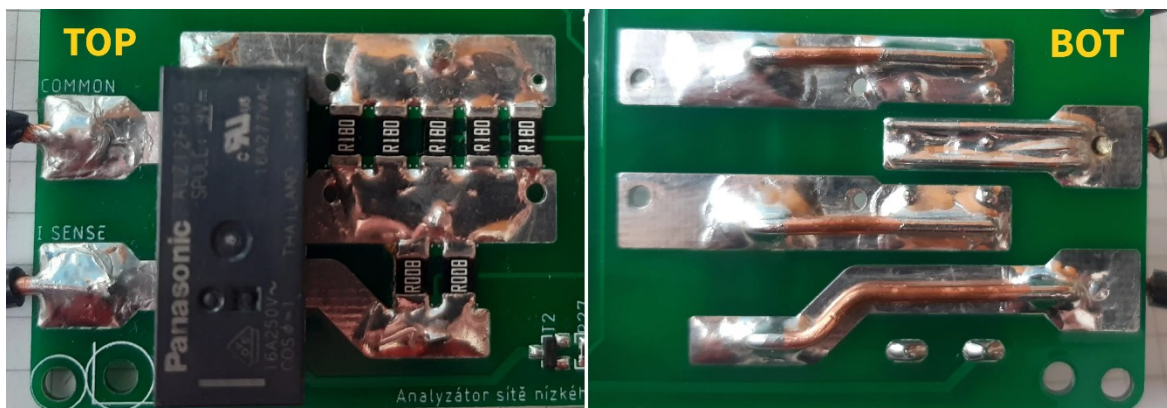
Obrázek 11: Zvětšení proudové kapacity vodivých cest na DPS pomocí vodičů
