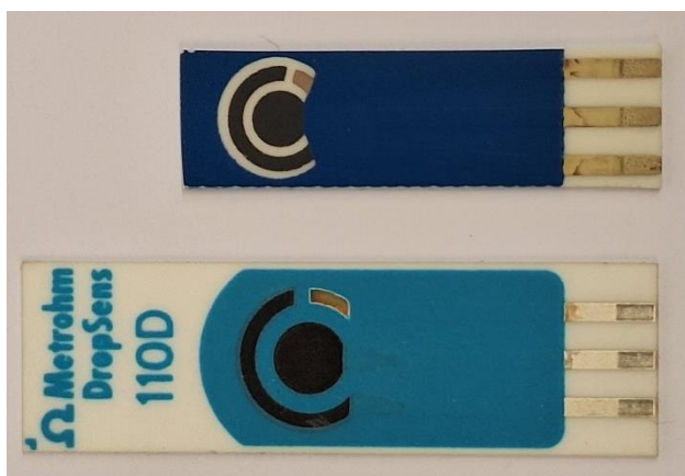
Obrázek 6 Tištěný senzor s borem dopovanou diamantovou elektrodou (nahore), uhlíková tištěná elektroda s nanotrubičkami (dole)
