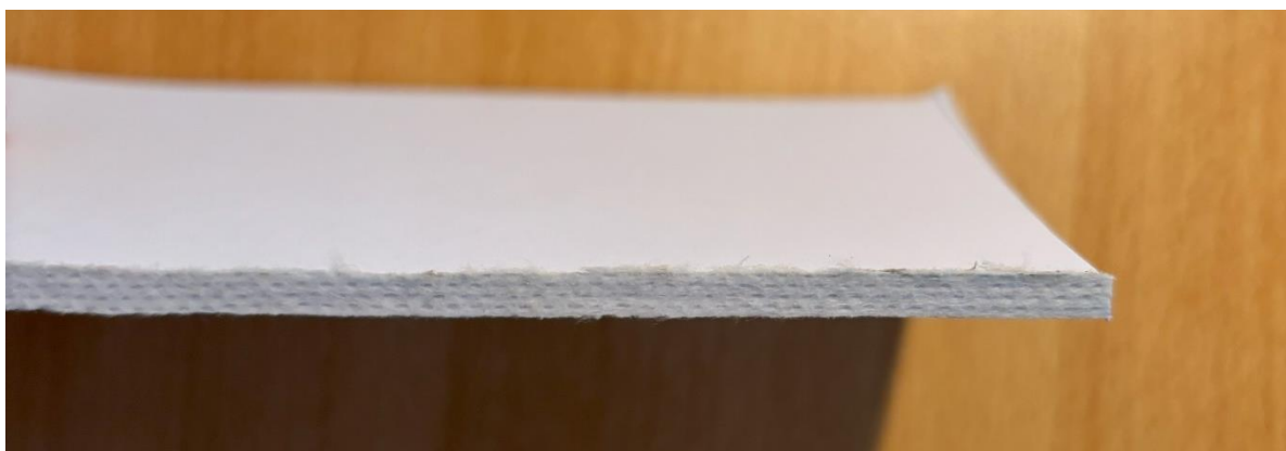
Obrázek 28: Oříznutí gázy od slepených listů u vazby V4
