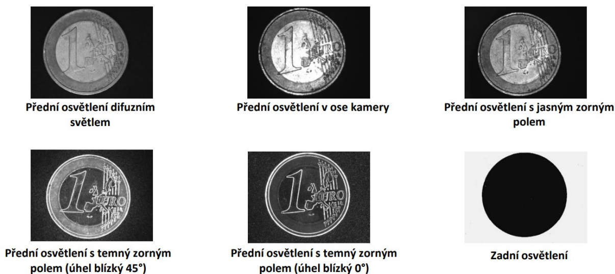
Obrázek 1.13 – Metody osvětlení objektu (Štursa, 2024)
