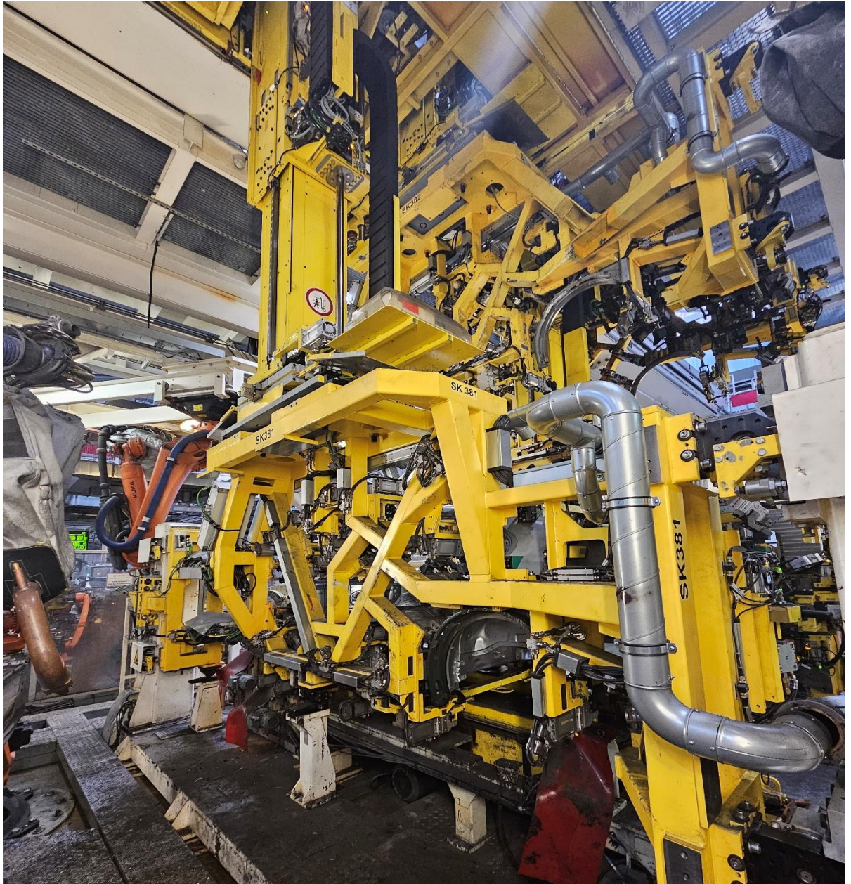
Obrázek 27: Framer – ocelový rám
