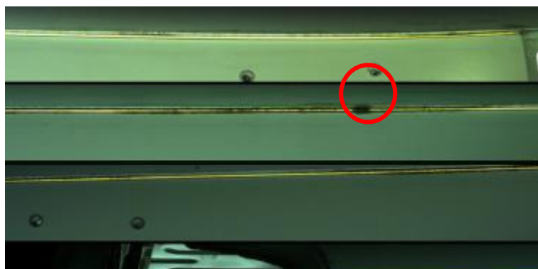
Obrázek 28: Aktuální zobrazení chybného sváru
