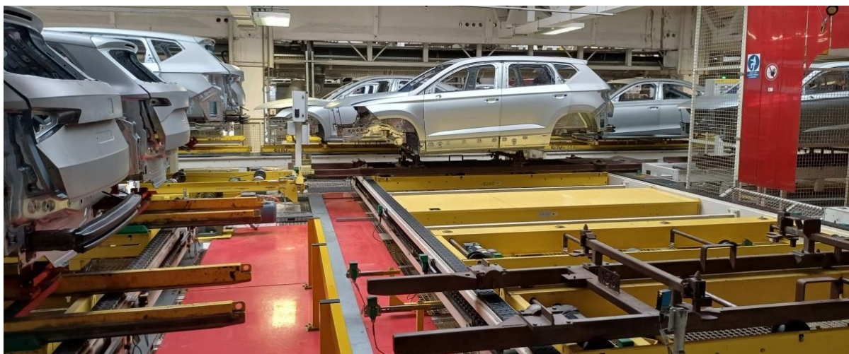
Obrázek 11: Přemístění karosérie na lakovenský dopravník
