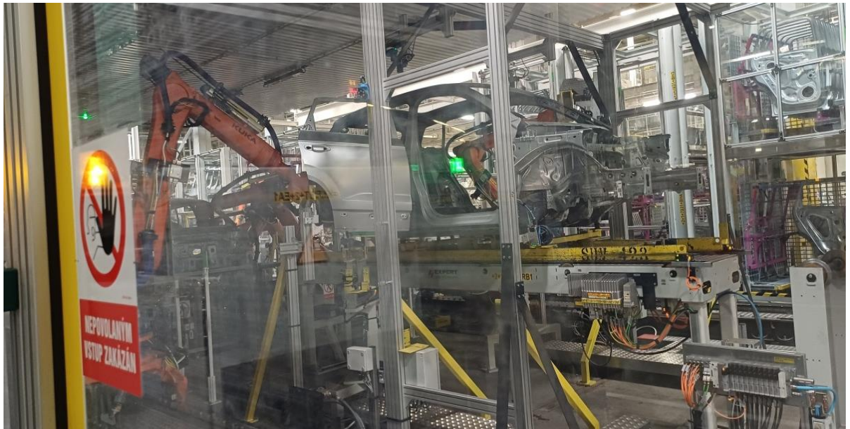
Obrázek 8: Automatické ustavení bočních dveří
