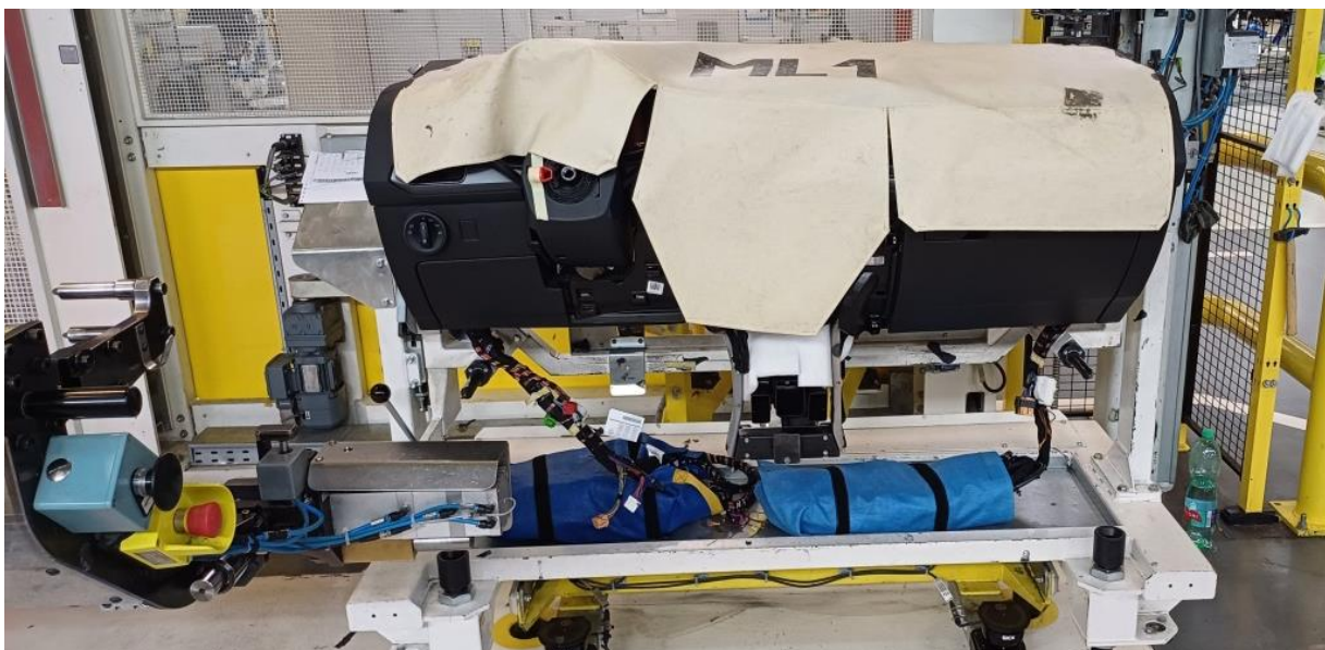
Obrázek 15: Smontovaný kokpit na manipulátoru
