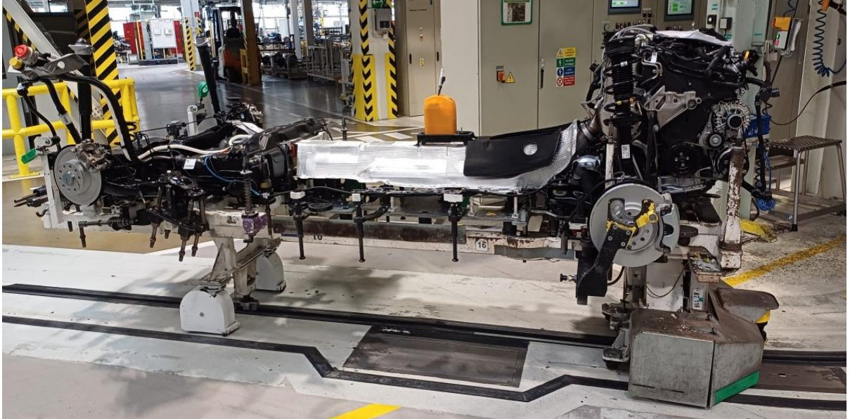
Obrázek 19: Podvozek vozidla připravený na svatbu
