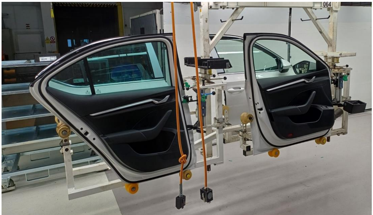
Obrázek 16: Kontrolní bod na lince dveří pro kontrolu elektrických funkcí
