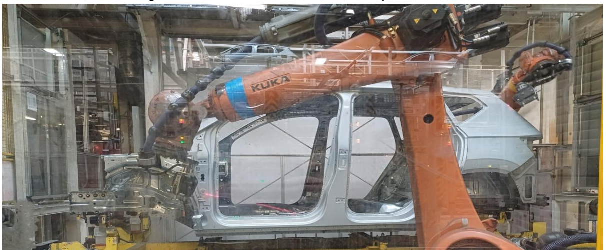
Obrázek 9: Inline měření pomocí 3D skeneru
