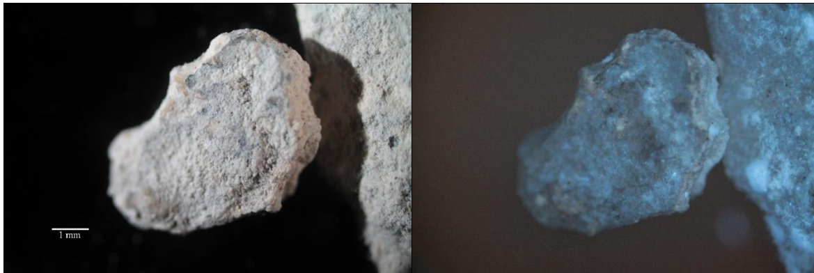
Obr. 33, 34 Optická mikroskopie, dokumentace vzorku z pohledové strany, bílé světlo, UV luminiscence.
