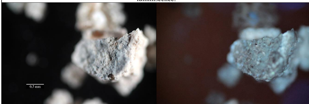
Obr. 14, 15 Optická mikroskopie, úlomek vzorku z pohledové strany, bílé světlo, UV luminiscence.
