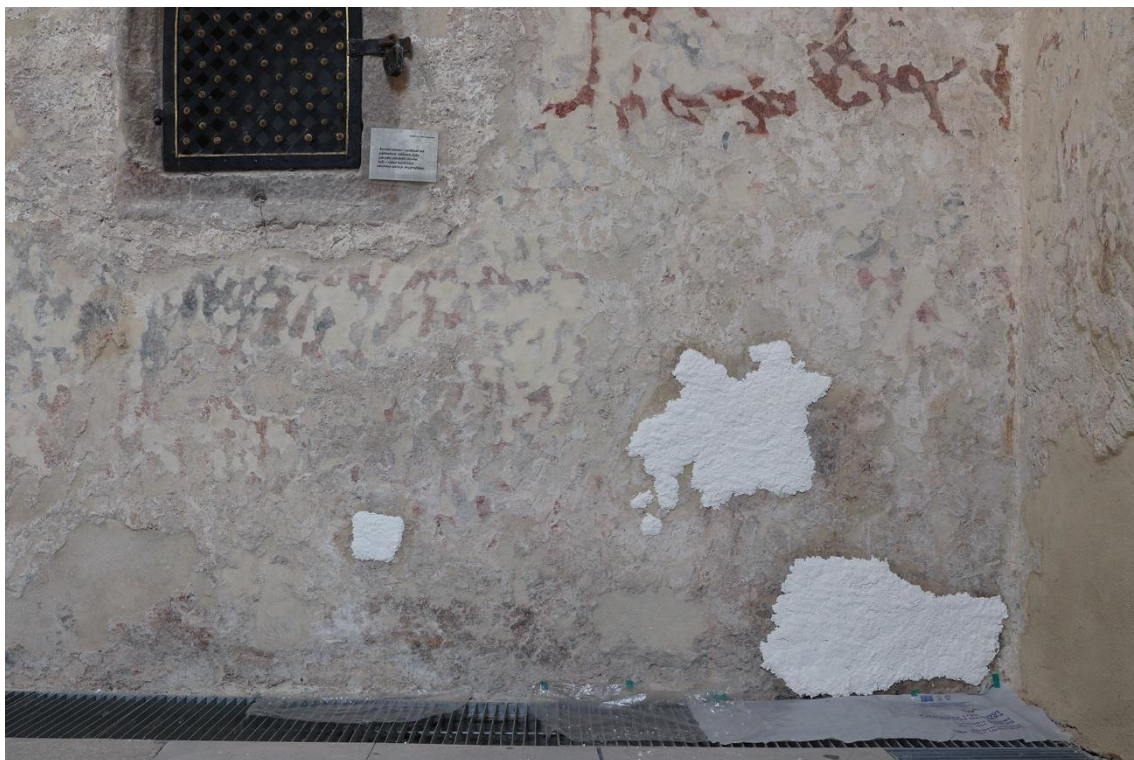
22. Severní stěna presbytáře, východní kout, spodní část – zkoušky zábalů s destilovanou vodou a uhlíčanem amonným.
