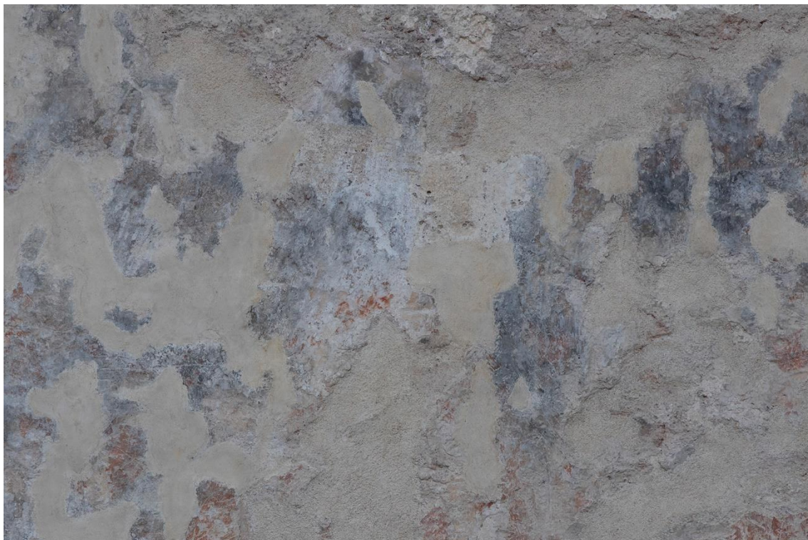
16. Severní stěna presbytáře, dole po sanktuářem – výsledek zkoušky obkladu s destilovanou vodou.
