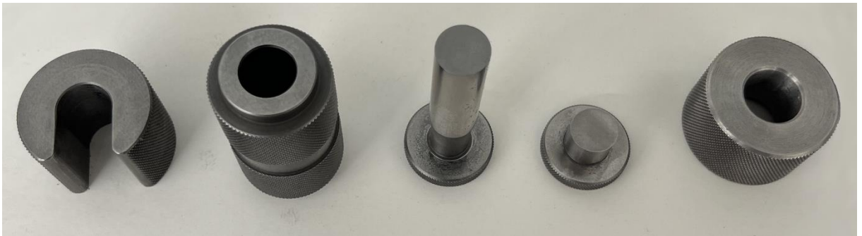
Obr. 12 Použitá lisovací souprava pro lisování pyrotechnické slože
