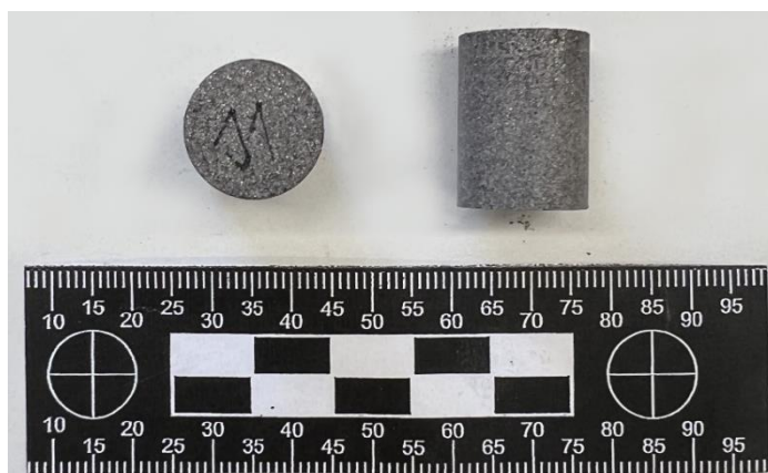
Obr. 14 Reálný připravený výlisek z granulátu PS pro mechanické testování
