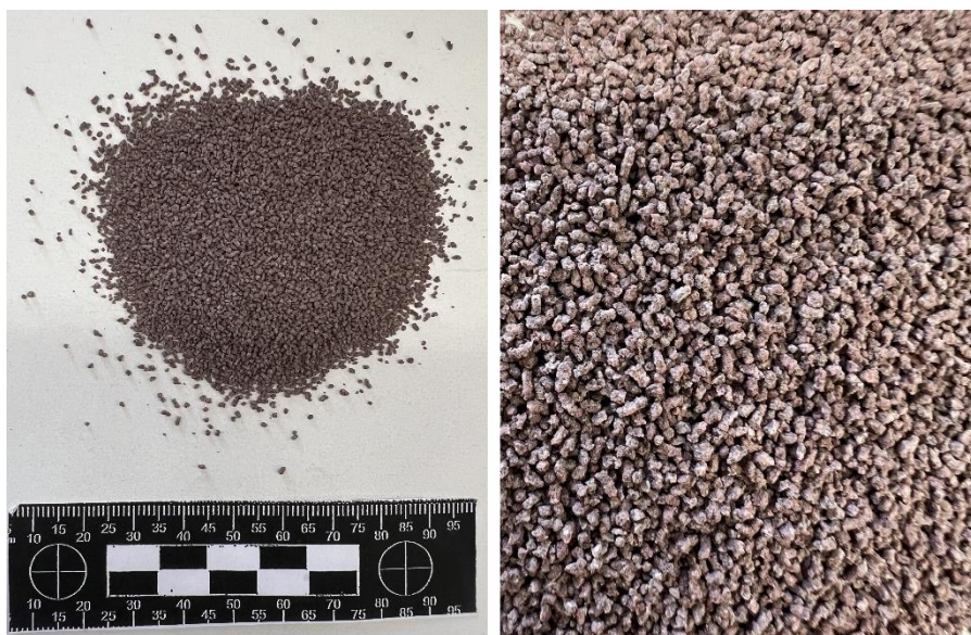
Obr. 11 Zážehová slož COP společně s detailem na jednotlivé granulky
