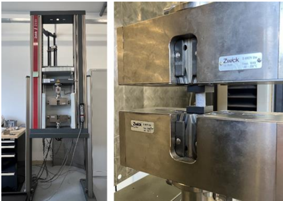
Obr. 16 Zařízení Zwick Roell Z030 a vložený výlisek do zařízení před měřením pevnosti
