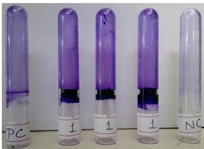
Obrázek 8: Zkumavková metoda pro detekci tvorby biofilmu – pozitivní kontrola (PC), negativní kontrola (NC), vzorek v triplikátu (1) (Kunwar et al. , 2021)
