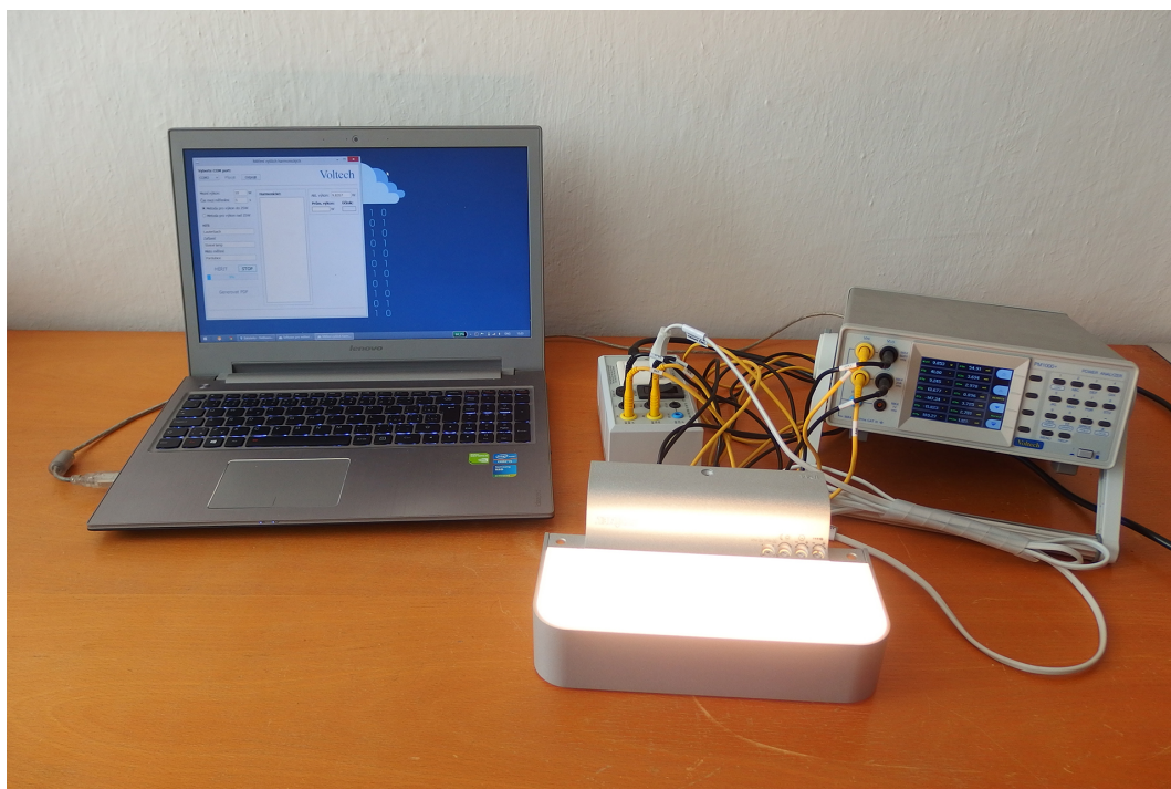
Obrázek 6: Pracoviště pro měření vyšších harmonických signálů
