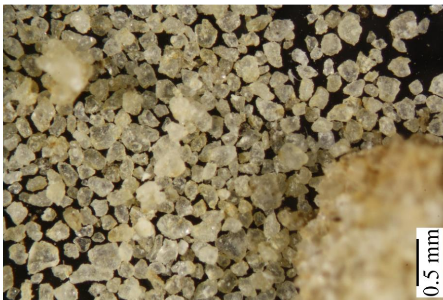
Obr. 1 pohled na subangulární zrna křemene fotografie pořízena pod mikroskopem
