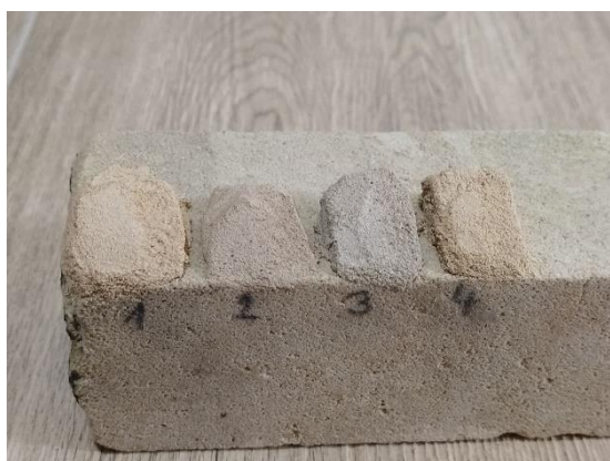
Obr. 18 zkoušky tmelů – vlevo kaolinový, vpravo vápenocementový
