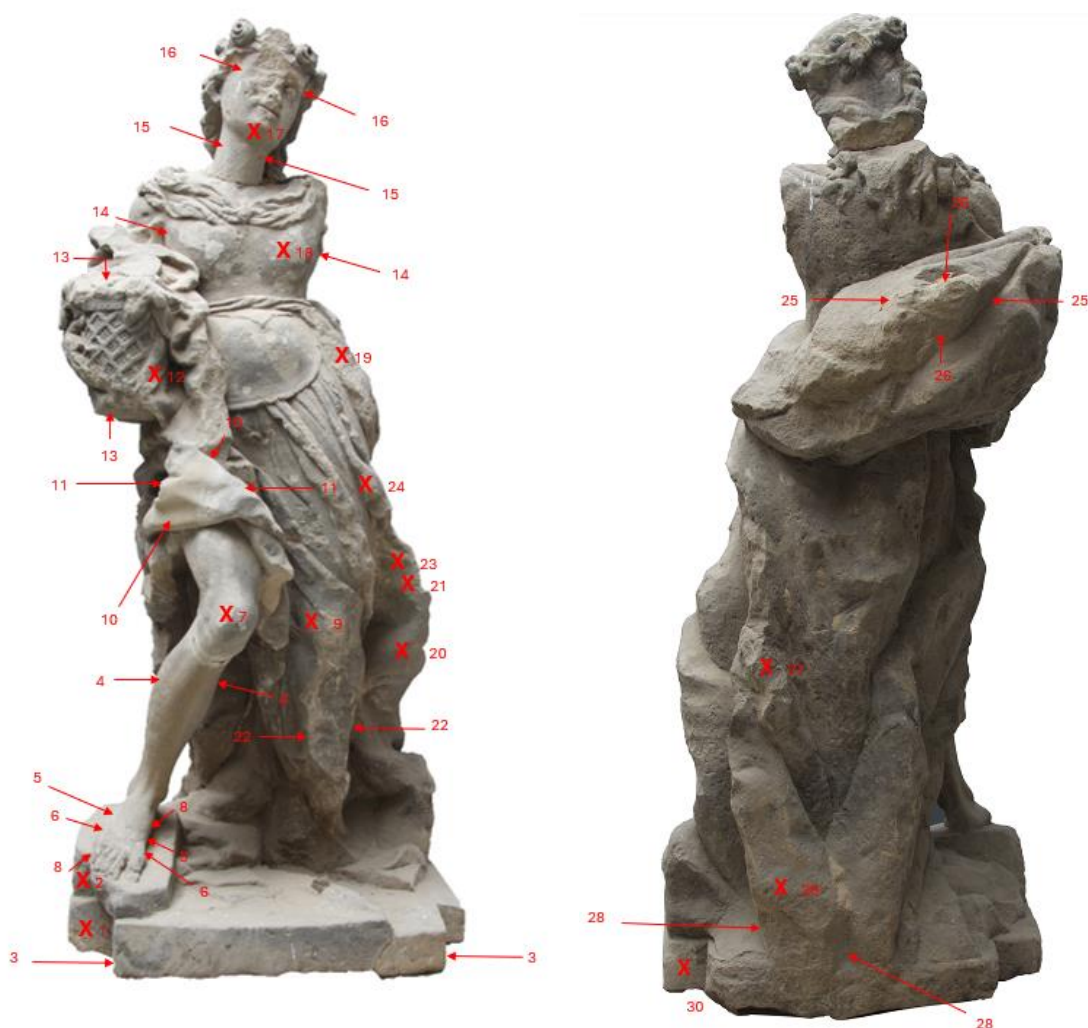
Obr. 12 zákresy měření ultrazvukové transmise – přední a zadní pohled
