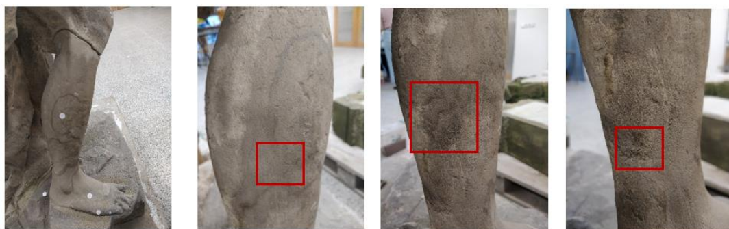
Obr. 16 fotografie zachycující zkoušky odstraňování šlemy vzniklém na výdusku následkem vsáknuté vody do materiálu při zkouškách nasákavosti – zleva: celkový pohled na výdusek se zateklinami, čištění isoocetanem, čištění acetonem, čištění parou
