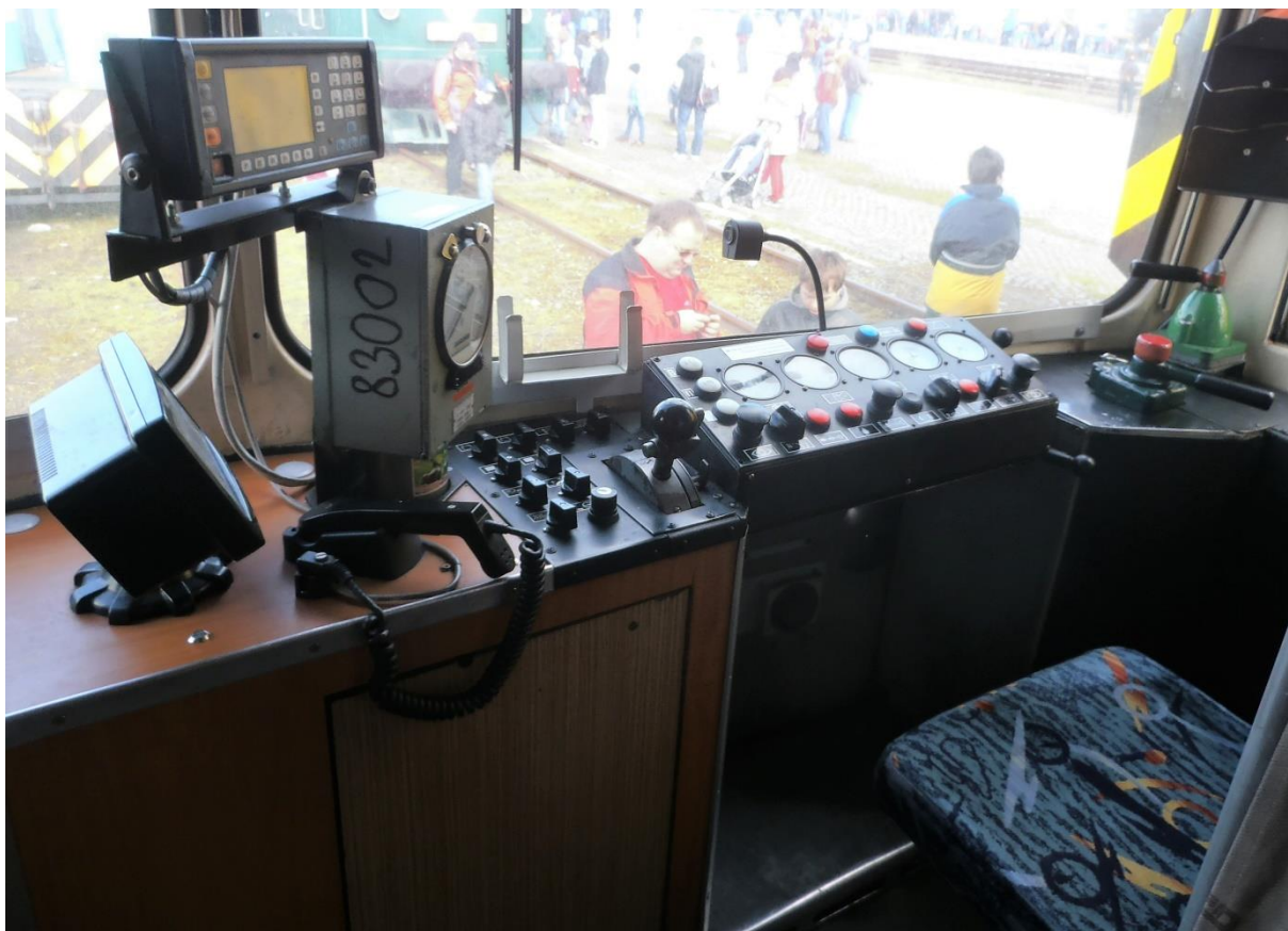
Obrázek 17 - Stanoviště strojvedoucího motorového vozu řady 810 ČD, vlevo nahoře ovládací panel vozidlové radiostanice T-CZ VS47. Autor fotografie: Dominik Řihák
