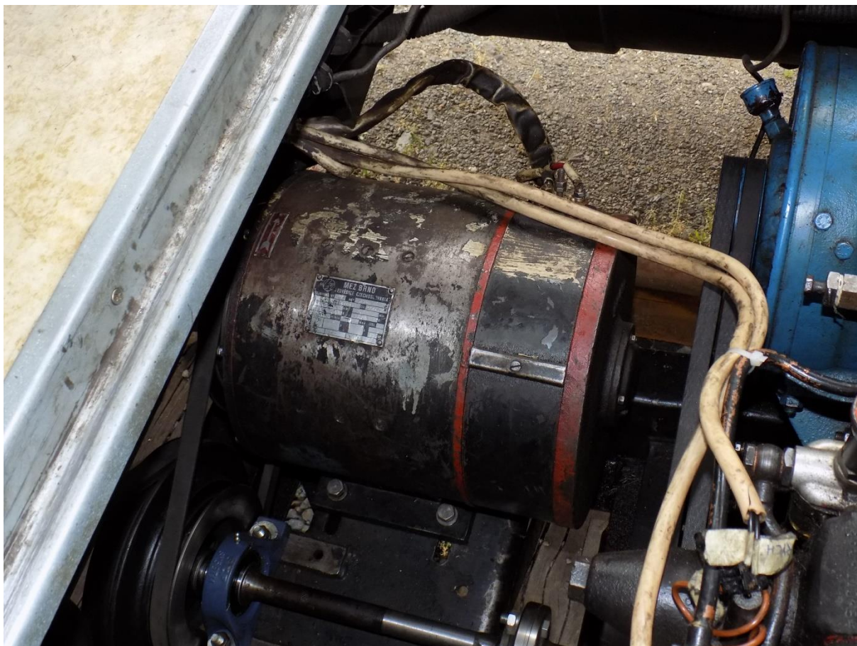
Obrázek 4 - Dynamo a část hřídele pomocných pohonů v motorovém voze M131.1454. Autor fotografie: Jan Židlík
