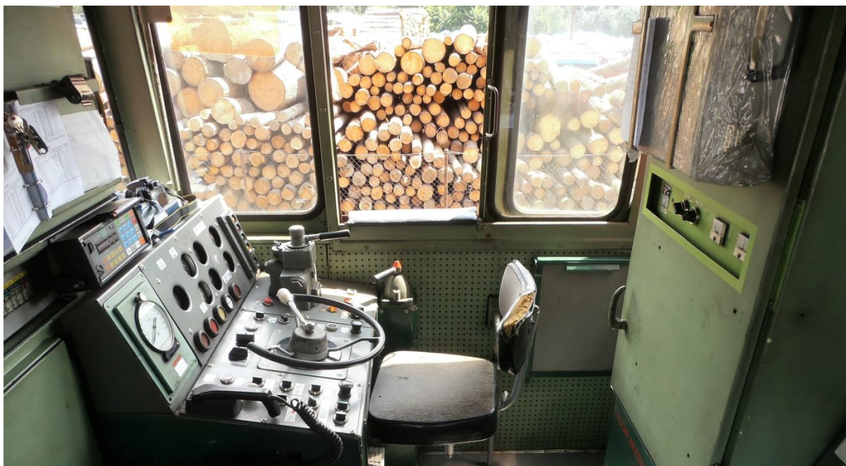
Obrázek 13 - Stanoviště strojvedoucího dieselelektrické lokomotivy řady 742 ČD, vpravo na skříni rozvaděče patrné měřicí přístroje baterie. Autor fotografie: Dominik Řihák
