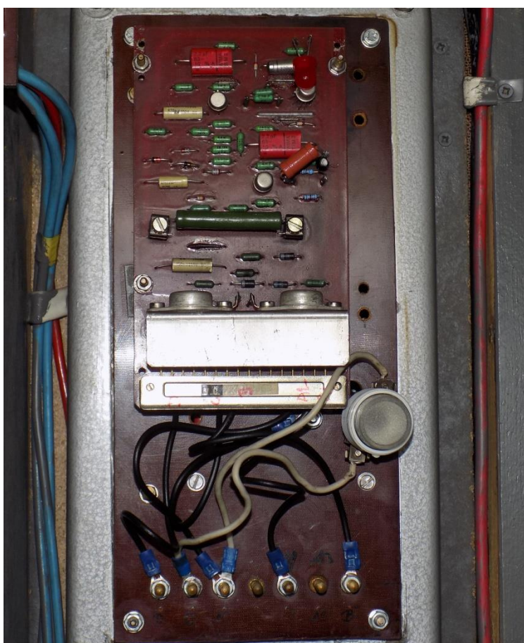
Obrázek 5 - Deska elektronického regulátoru dobíjení ve voze M131.1454. Autor fotografie: Jan Židlík
