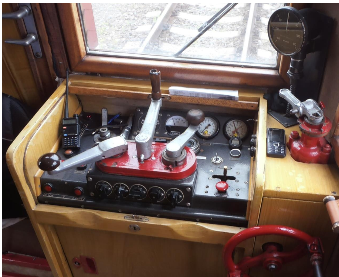
Obrázek 10 - Ovládací prvky integrované v pultu na stanovišti strojvedoucího motorového vozu M131.1454. Autor fotografie: Dominik Řihák
