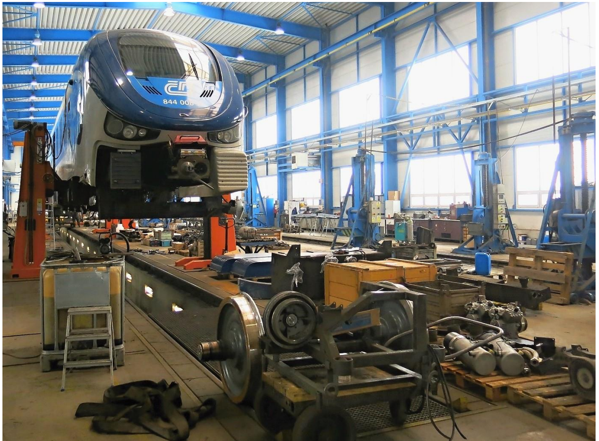
Obrázek 12 - Motorová jednotka ČD 844.008 během vyvazovací opravy. Autor fotografie: Stanislav Plachý
