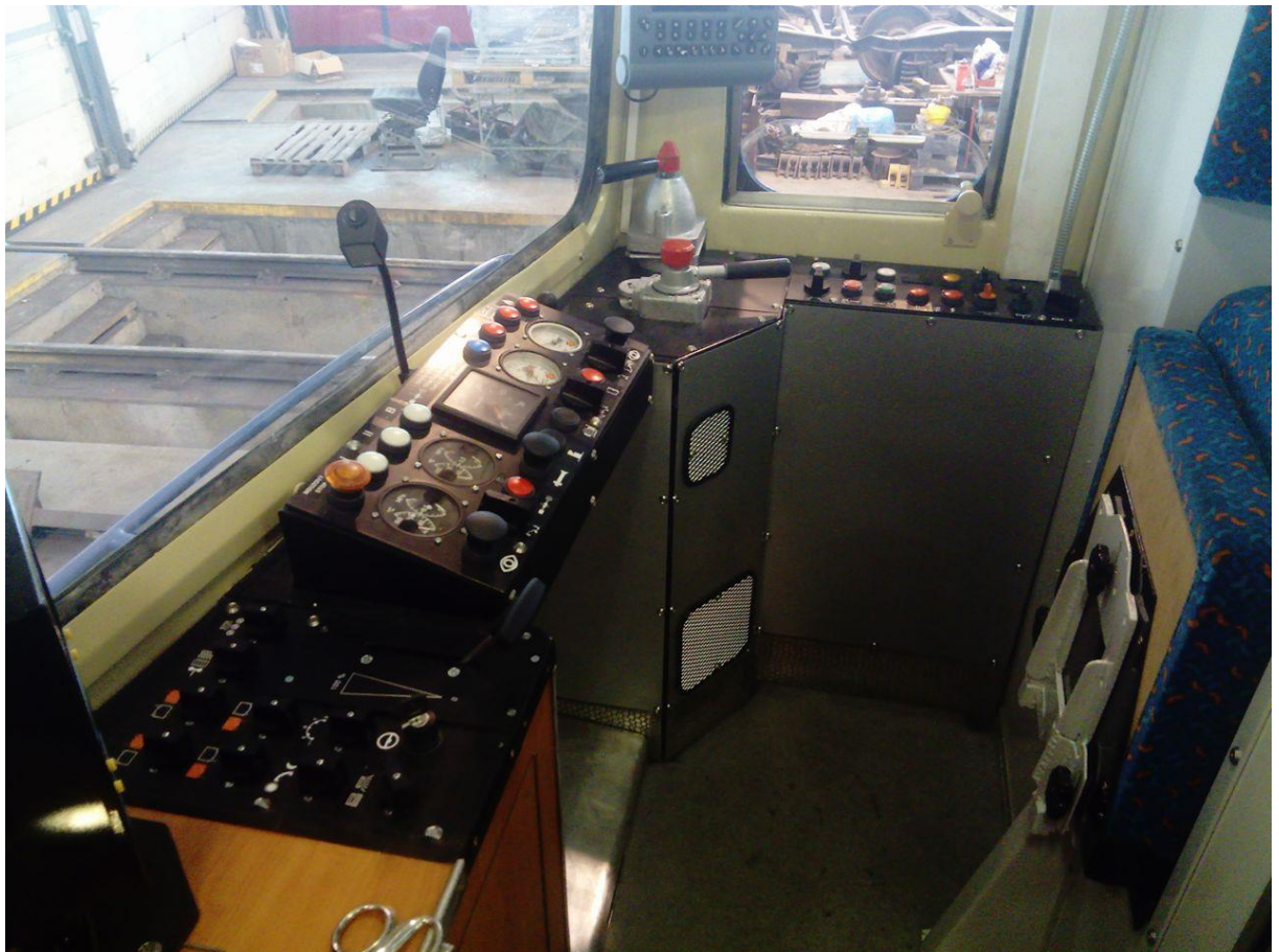
Obrázek 11 - Stanoviště strojvedoucího v rekonstruovaném motorovém voze řady 810 ČD. Autor fotografie: Jan Židlík
