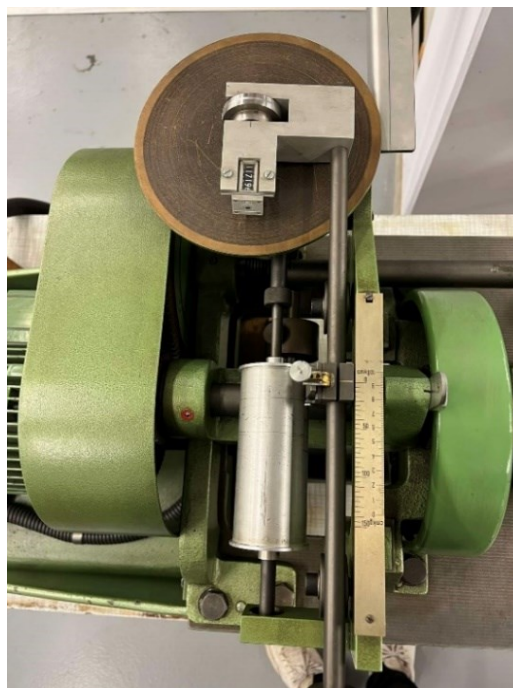
Obrázek 10 Převodový mechanismus a zapisovací zařízení
