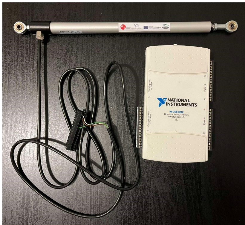
Obrázek 12 Lineární snímač polohy a sběrnice dat
