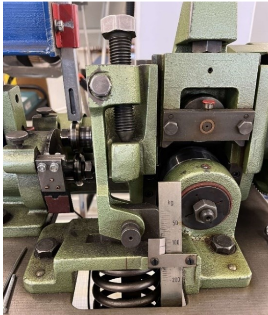
Obrázek 9 Ústrojí pro přítlak kotoučů na zkušebním stroji Amsler A-135
