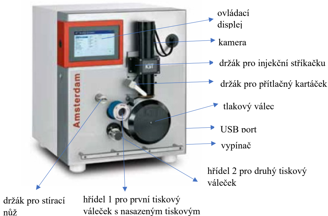
Obr.1: Potiskovací přístroj IGT Amsterdam 2
