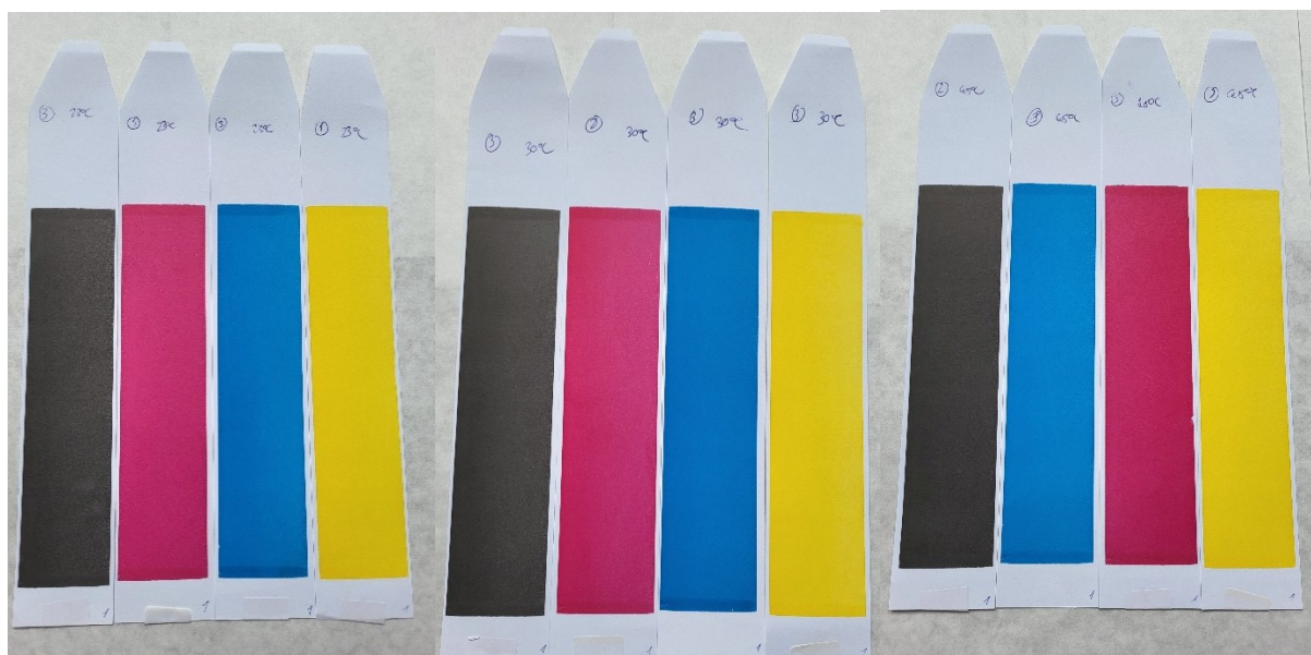
Obr. 3 Přenos tiskové barvy na ofsetový papír při 23 °C, 30 °C a 45 °C
