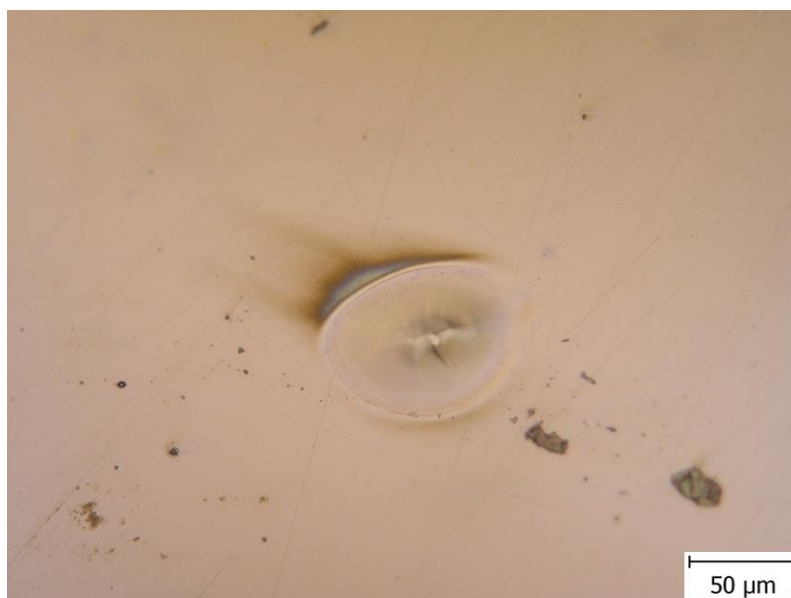
Obr. 16 Kráter vytvořený intenzitou 64 % ve vzorku 0,5 Ni.
