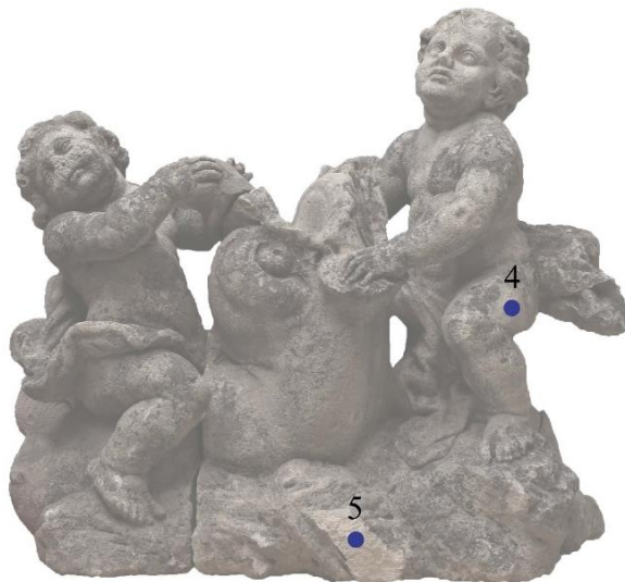
Obrázek 16 místa měření nasákavosti, přední strana
