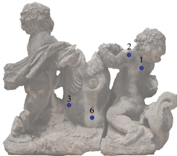
Obrázek 17 místa měření nasákavosti, zadní strana
