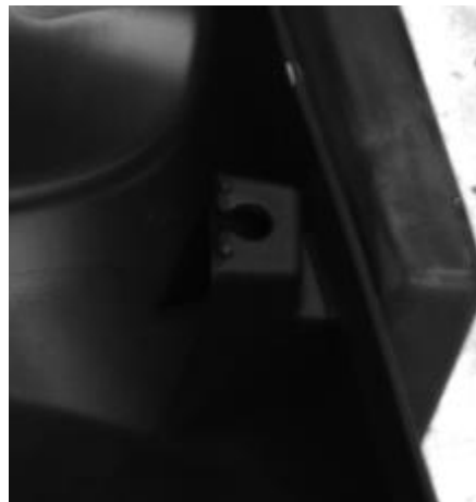
Obrázek 5.2 Detail místa pro zacvaknutí komponentu
