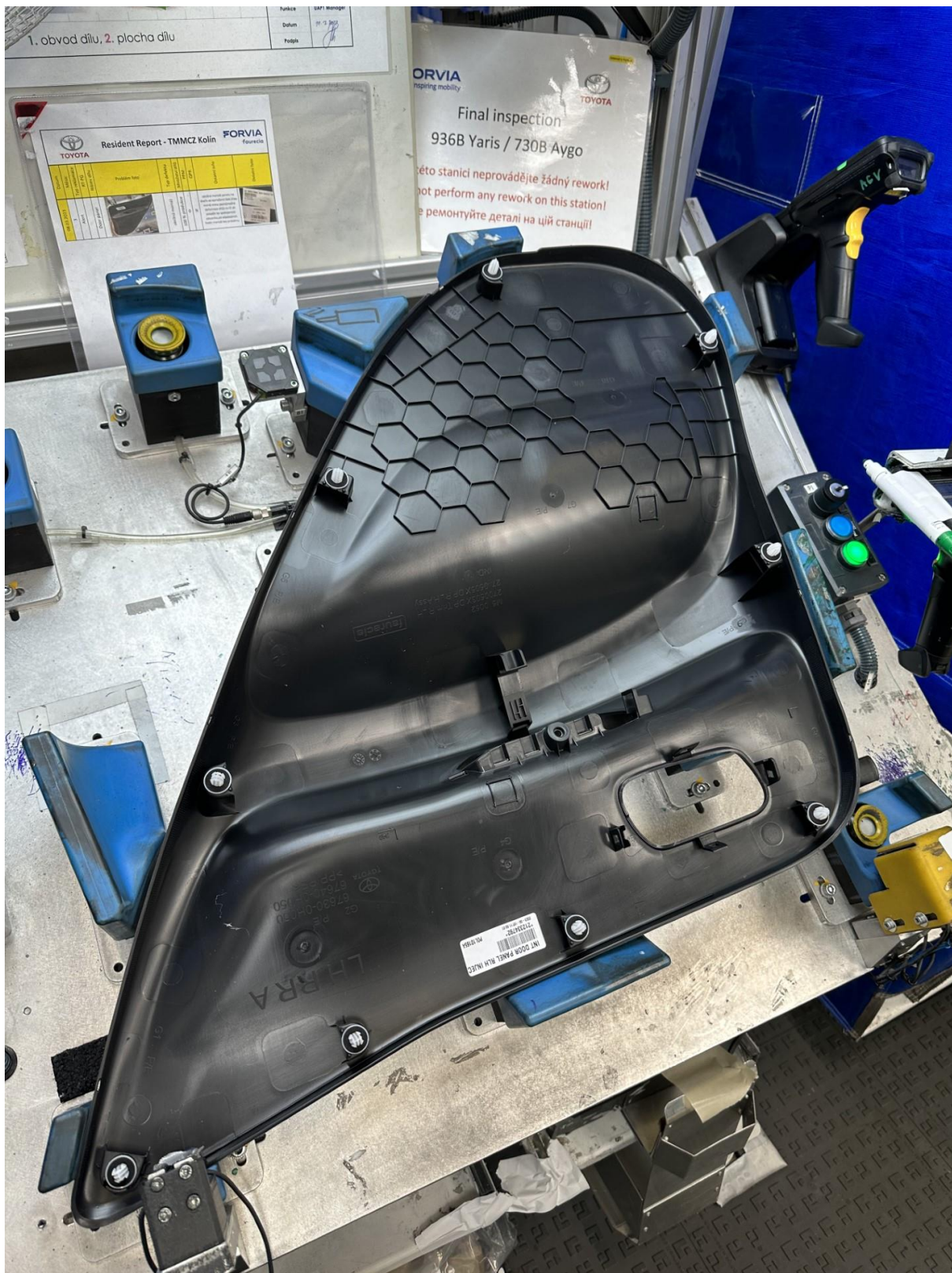
Obrázek 5.1 OK díl připravený na kontrolu
