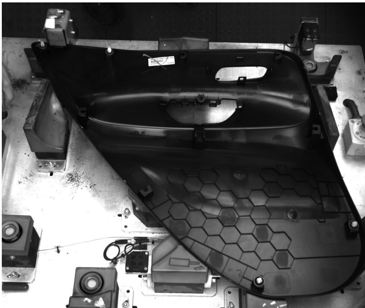
Obrázek 5.6 NOK díl s chybějícími součástmi.
