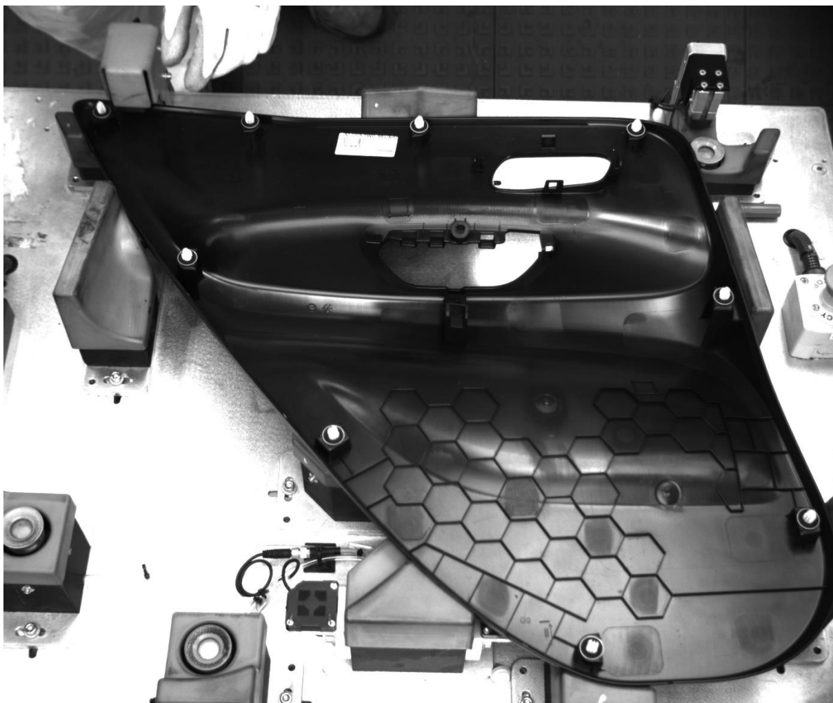
Obrázek 5.4 OK díl připravený ke kontrole - foceno kamerou na stanici.
