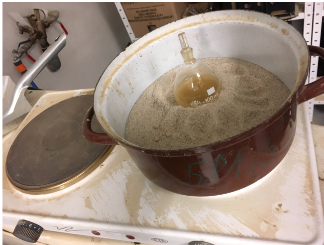
Obr. 6 Vzorek v pyknometru a pískové lázni a určení teploty pomocné kapaliny
