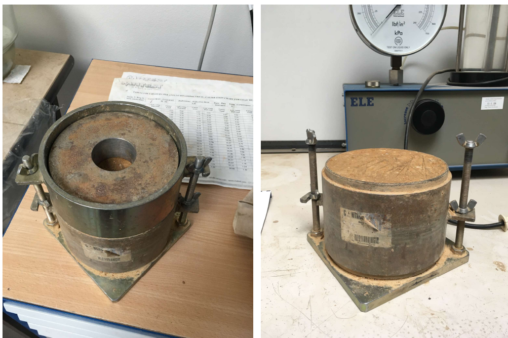
Obr. 10 Vzorek zatížený prstencem připravený pro zkoušku CBR
