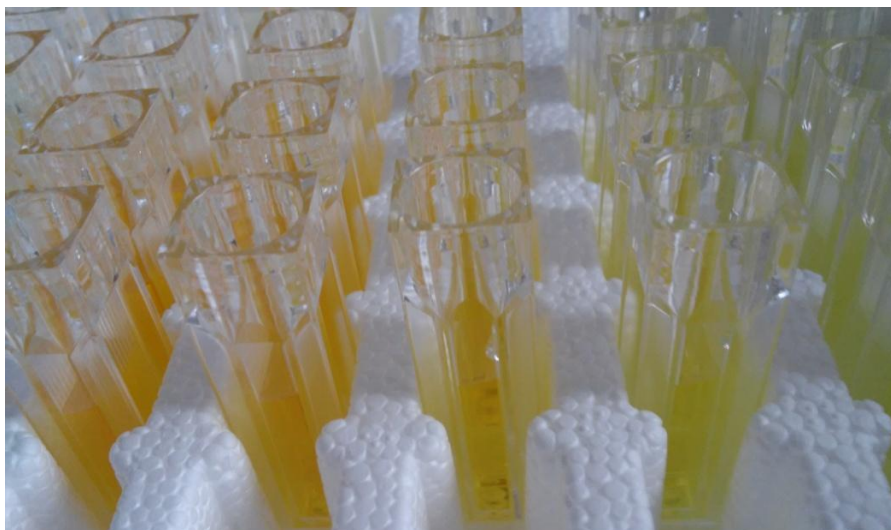
Obrázek 11: Kyvety, ve kterých probíhá reakce pro měření aktivity Ellmanovou metodou
