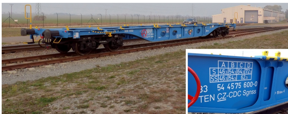
Obrázek 7: Nákladní vůz řady Sgnss 60 dopravce ČD Cargo od výrobce OOS Ostrava
