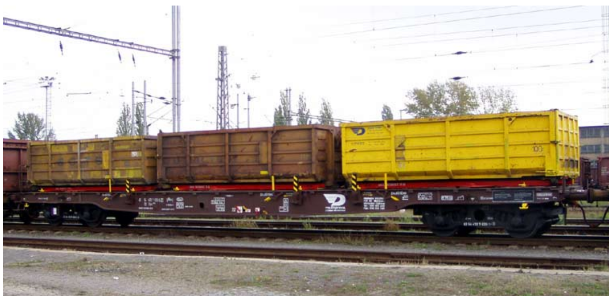
Obrázek 20: Nákladní vůz řady Slps s nákladem odvalovacích kontejnerů ACTS
