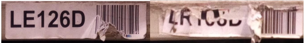
Obrázek 26 Čárové kódy nečitelné pro čtecí zařízení (autor)
