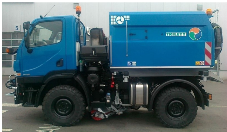
Obrázek 2 Silniční zametací stroj pro úzké průjezdy (Hradecké služby a. s., 2024)
