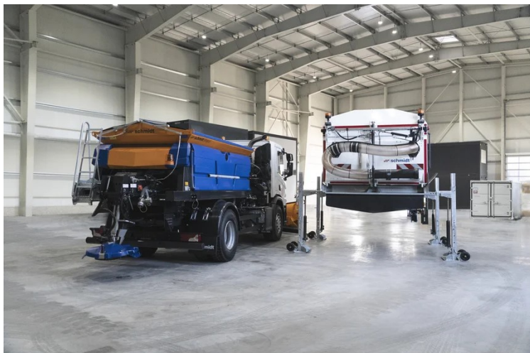
Obrázek 24 Proces výměny vybavení z letní do zimní údržby (Aebi Schmidt, 2025)
