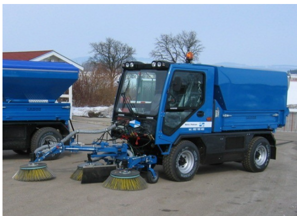
Obrázek 3 Chodníkový zametací stroj (Hradecké služby a. s., 2024)
