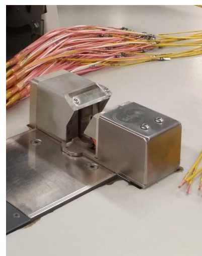
Zdroj: Autorka Obrázek č. 10 – ultrazvuková svařovačka
