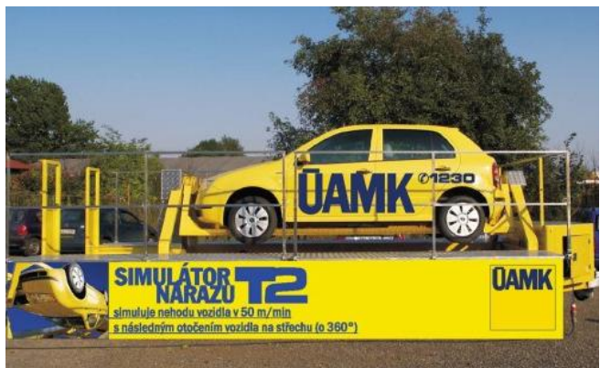
obr. 2-3 Simulátor převrácení vozu institutu ÚAMK [1]
