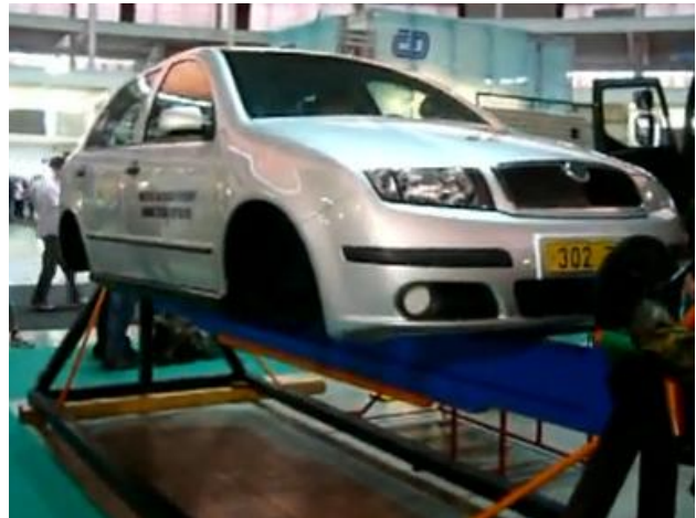
obr. 2-1 Simulátor převrácení vozu institutu AČR [13]
