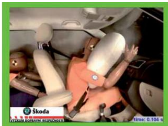
Maximální zaboření, začíná zpětný pohyb
