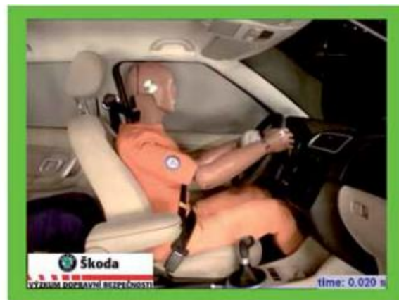
Aktivace předepínačů pásů a airbagu
