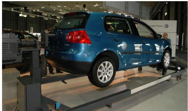
obr. 2-2 Simulátor převrácení vozu VW [12]
