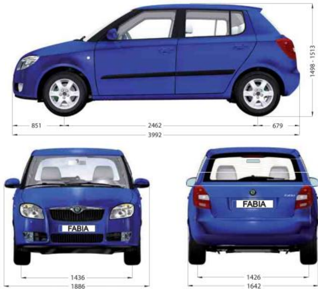
obr. 2-7 Škoda Fabia druhé generace - celkové rozměry [11]
