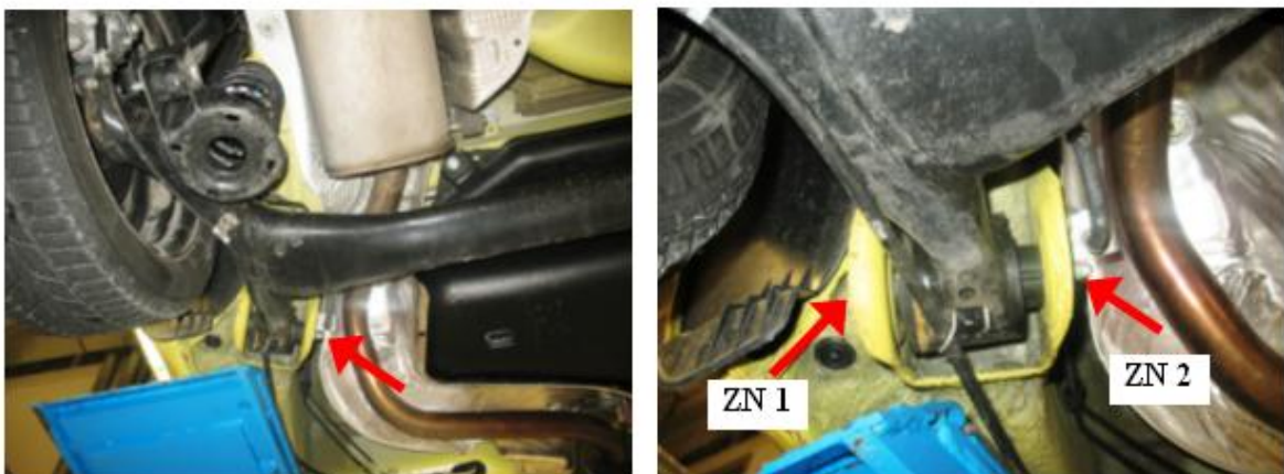
obr. 3-6 Zvolené upevňovací body pro zadní nápravu
