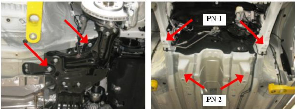
obr. 3-5 Zvolené upevňovací body pro přední nápravu
