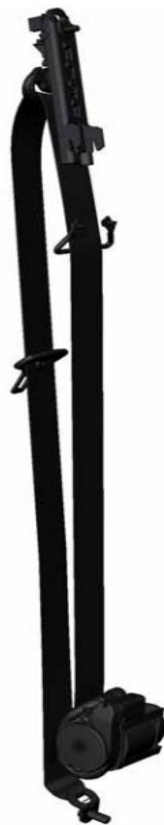
obr. 1-1 tříbodový bezpečnostní pás [2]
