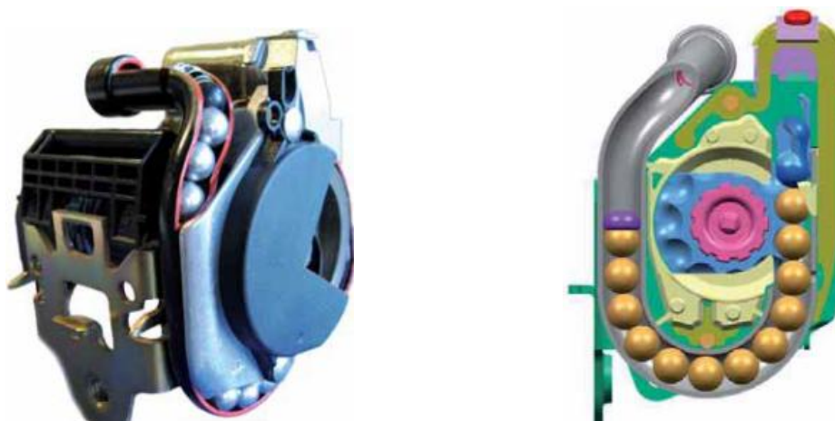
obr. 1-2 funkce pyrotechnického předepínače pásů [2]
