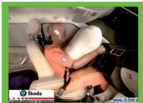
Airbag je naplněn, omezovač začíná popouštět pás
