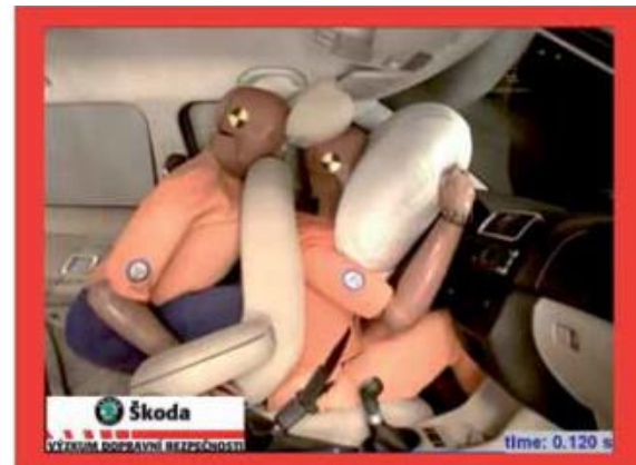
Kontakt hrudníku a hlavy spolujezdece s opěradlem
